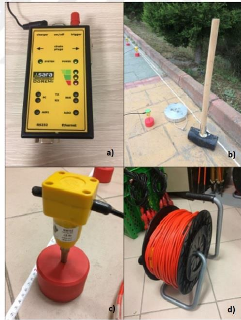
Şekil 4.1. MASW yönteminde kullanılan ekipman; a) Cihaz, b) Enerji kaynağı, c) Jeofon, d) Kablo [17]
