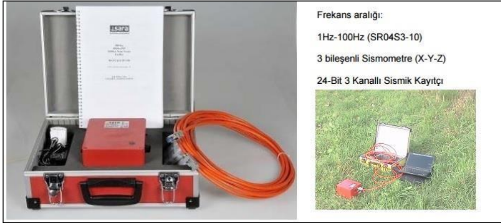
Şekil 3.21. Mikrotremör ölçümlerinde kullanılan cihazın görüntüsü ve özellikleri
