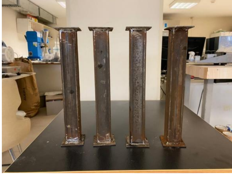
Şekil 3.3. Korozyon hasarına uğramayan profil örneği
