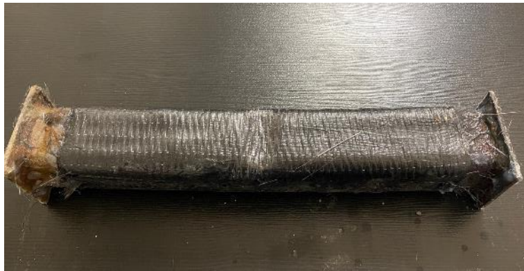
Şekil 4.28. CFRP ile güçlendirilmiş %20 korozyon hasarlı profilin eğilme testi sonrası
