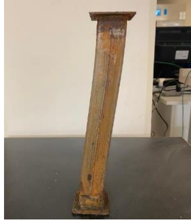
Şekil 4.1. Kütüce %20 korozyon hasarlı profil basınç testi sonrası
