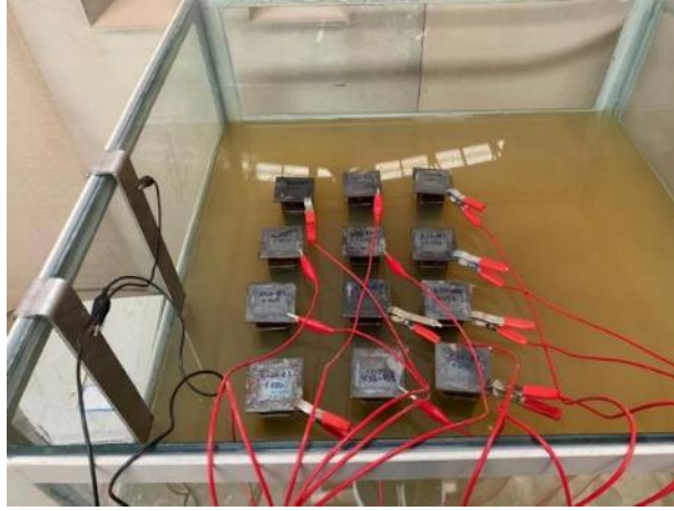
Şekil 3.19. Hızlandırılmış korozyon test düzeneği
