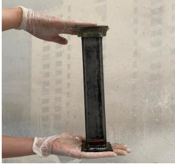
Şekil 3.26. Korozyon atıklarından temizlenen profil
