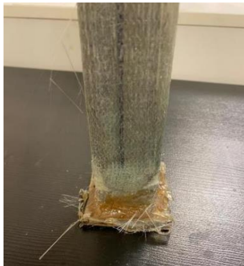
Şekil 4.22. GFRP ile güçlendirilmiş %20 korozyon hasarlı profilin basınç testi sonrası
