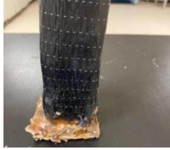
Şekil 4.14. CFRP ile güçlendirilmiş %10 korozyon hasarlı profilin basınç testi sonrası
