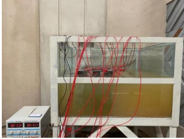
Şekil 3.18. Hızlandırılmış korozyon test düzeneği
