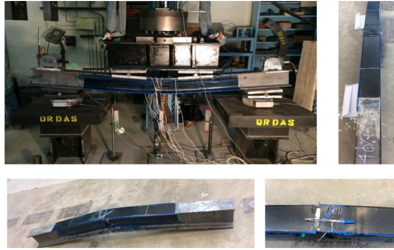
Şekil 2.14. CFRP ile güçlendirilmiş profillerin eğilme testi sonrası [53]
