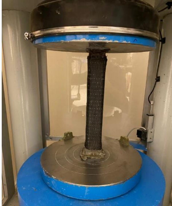
Şekil 3.38. Güçlendirilmiş profil basınç testi
