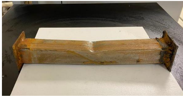
Şekil 4.3. Kütlece %20 korozyon hasarlı profil eğilme testi sonrası
