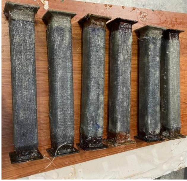
Şekil 3.34. GFRP ile güçlendirmesi tamamlanmış profiller
