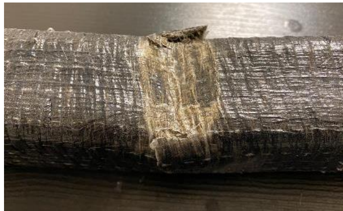
Şekil 4.10. BFRP ile güçlendirilmiş korozyon hasarsız profilin eğilme testi sonrası
