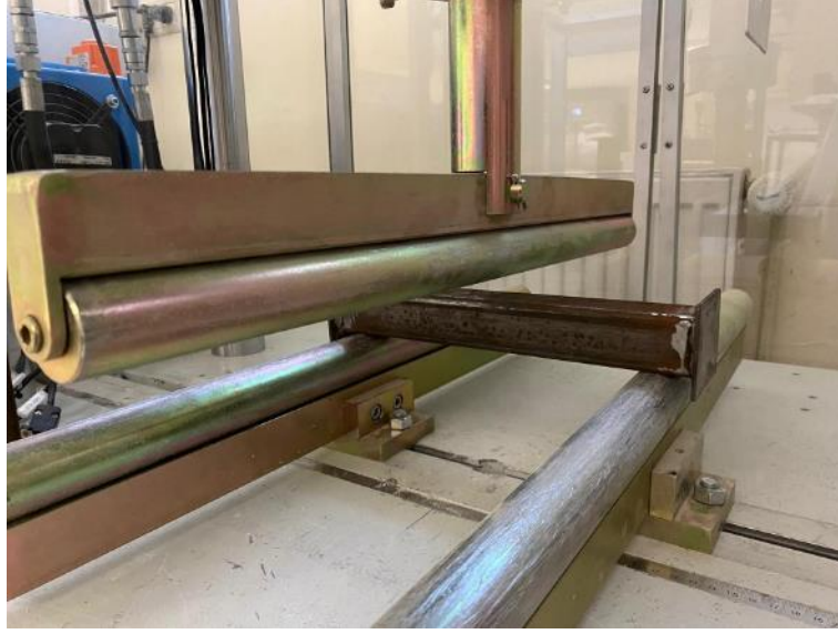
Şekil 3.40. Güçlendirilmemiş profil eğilme testi
