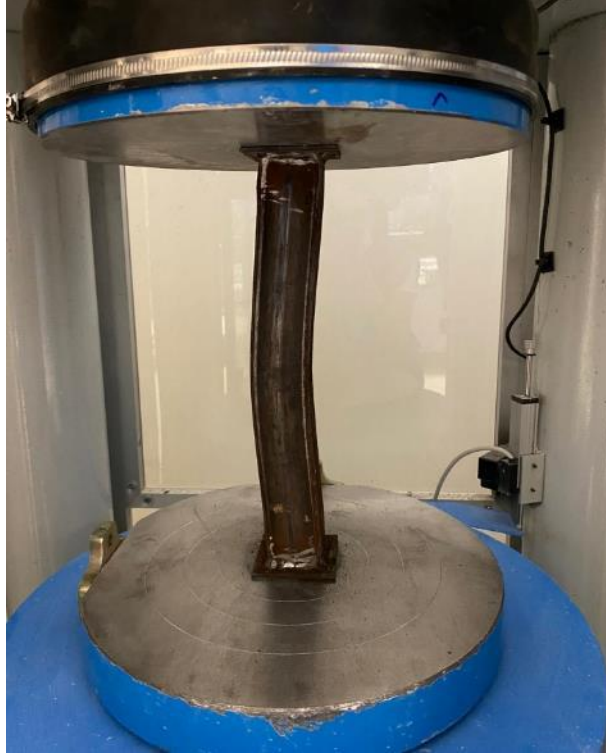
Şekil 3.37. Güçlendirilmemiş profil basınç testi
