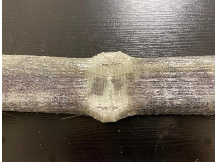
Şekil 4.27. GFRP ile güçlendirilmiş %20 korozyon hasarlı profilin eğilme testi sonrası
