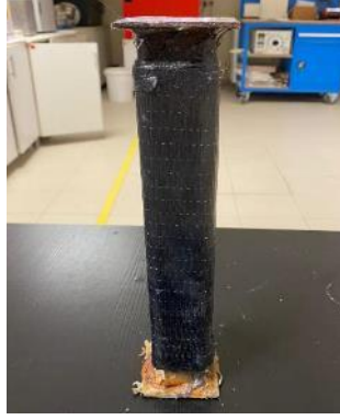
Şekil 4.23. CFRP ile güçlendirilmiş %20 korozyon hasarlı profilin basınç testi sonrası
