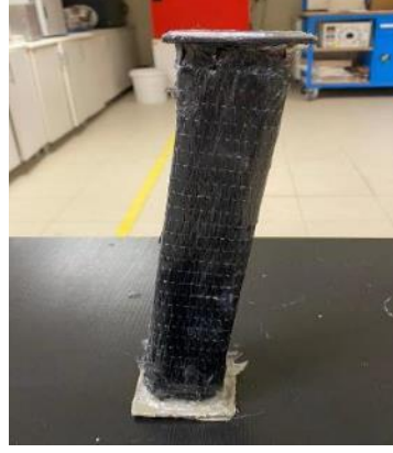
Şekil 4.6. CFRP ile güçlendirilmiş korozyon hasarsız profilin basınç testi sonrası
