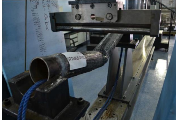
Şekil 2.9. CFRP ile güçlendirilmiş numunelerin eğilme testi [20]
