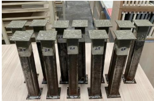
Şekil 3.17. Korozyon hasarına uğrayacak kısımlar
