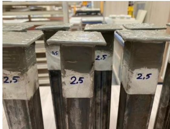
Şekil 3.22. Başlıkların su yalıtım malzemesi ile kaplanması
