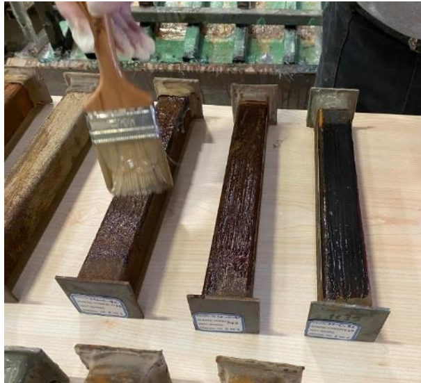
Şekil 3.30. İlk kat güçlendirme öncesi polyester reçine uygulaması
