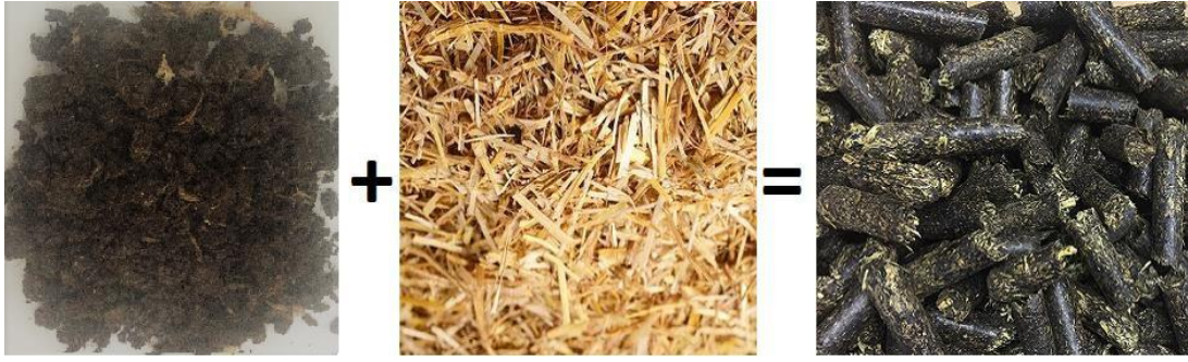
Şekil 3.2. Kurutulmuş arıtma çamuru, Arundo donax samanı ve bunların 50:50 karışımından üretilmiş biyo-pelet
