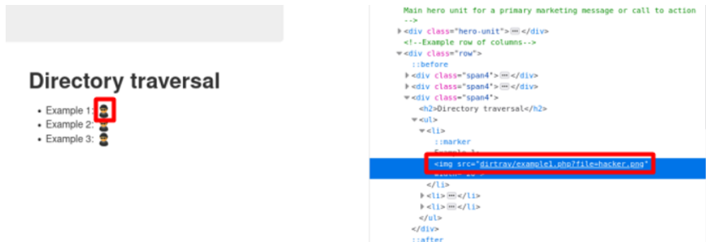
Şekil 3.4. Sunucu üzerinde dizin erişimi sağlanan noktaların belirlenmesi.
