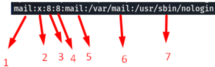
Şekil 4.4. etc/passwd dosyasında bulunan kullanıcı bilgisi formatı örneği
