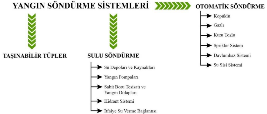
Şekil 4.56. Yangın Söndürme Sistemleri
