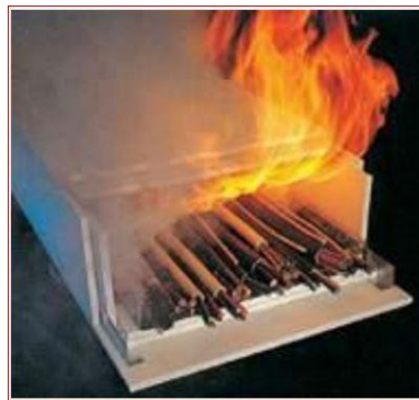
Şekil 4.9. Kablo kanallarında alçı levha [18]
