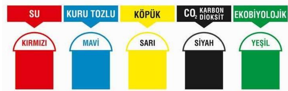
Şekil 4.57. Taşınabilir yangın tüplerinin renk kodları [61]
