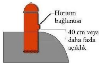
Şekil 4.52. Hidrant konumlandırılması [7]
