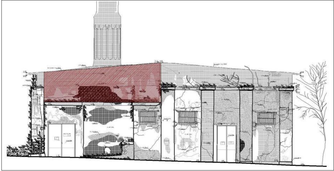
Şekil 5.133. Bacalı Ambar Kuzey Cephesi rölövesi
