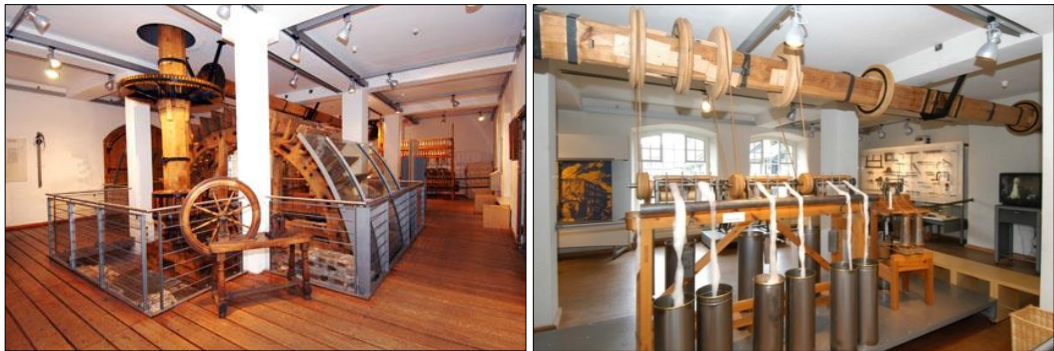
Şekil 6.38. Hammadde halindeki pamuğun dövülme, gerilme, bükülme işlemlerinin yapıldığı makinalar
