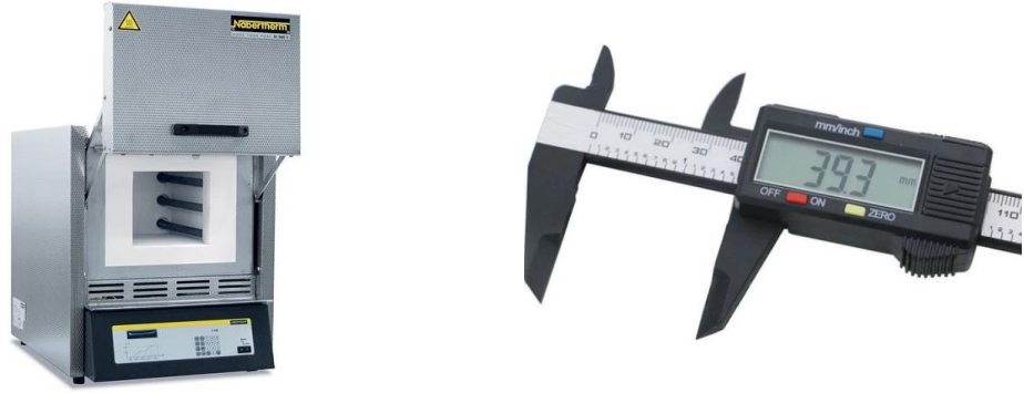
Şekil 6.3. Oksidasyon testlerinde kullanılan Nabertherm fırın ve numune ölçümlerinde kullanılan AEK-Tech Dijital Kumpas
