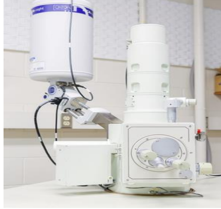
Şekil 6.5. Jeol marka JSM 6060 LV model Taramalı Elektron Mikroskobu cihazı
