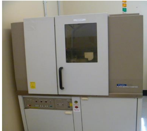
Şekil 6.4. Rigaku marka D/MAX 2000 model X-Işınları cihazı.
