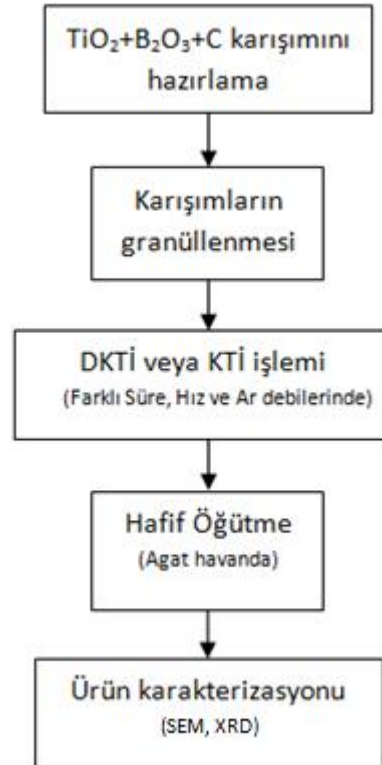
Şekil 3.2. B 4 C/TiB 2 ikili kompozit toz üretim işlemi iş akış şeması.
