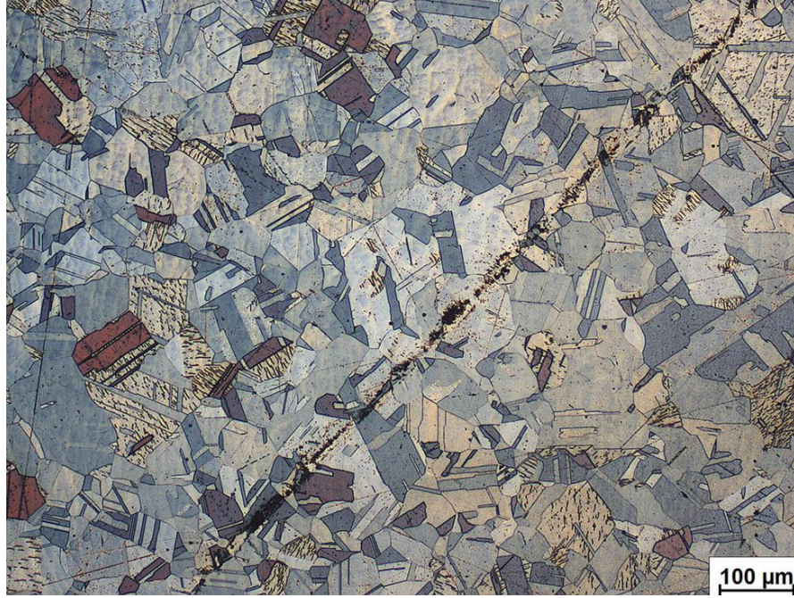
Şekil 2.38. Östenitik paslanmaz çelik mikro yapısı [69].
