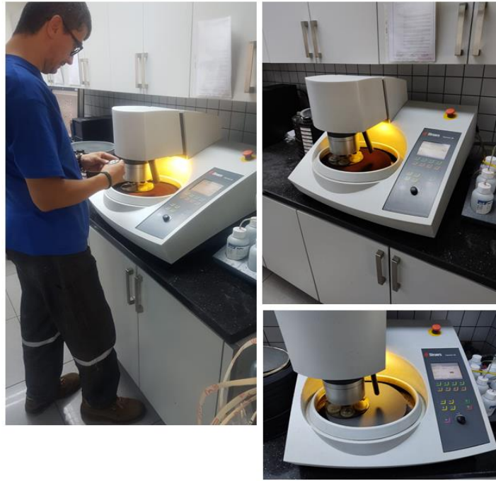
Şekil 3.14. Struers Tegamin 30 metalgrafik numune hazırlama cihazı.
