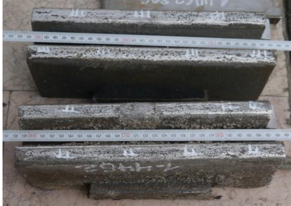
Şekil 3.1. Deneysel çalışma için üretilen 1.4410 ve 1.4462 kalite test blokları.
