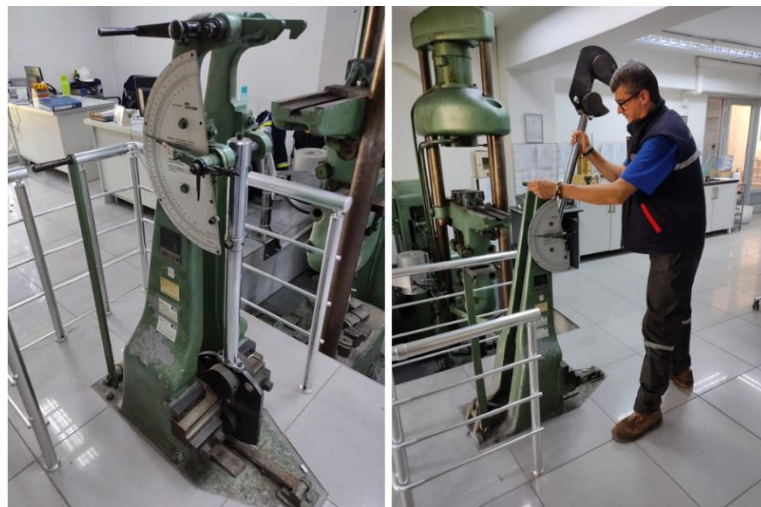
Şekil 3.9. 300 joule Losenhausewerk marka test cihazı.
