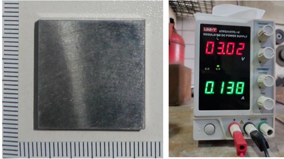
Şekil 3.20. ASTM A923-03 Method A korozyon testi görselleri.
