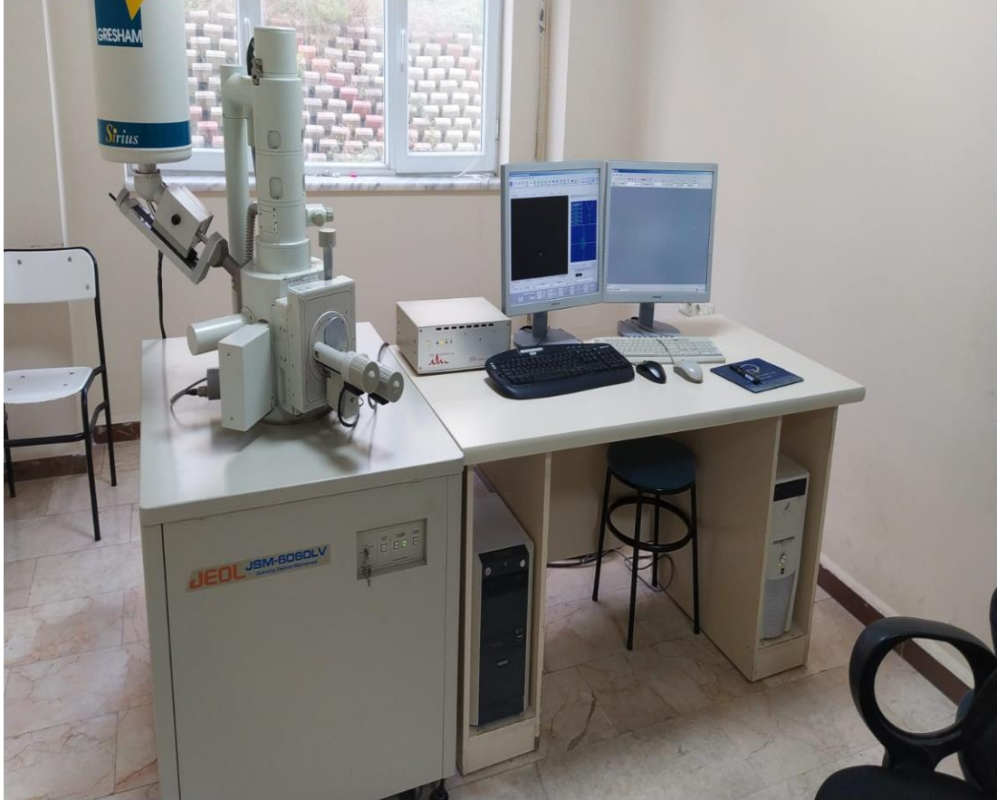
Şekil 3.17. JEOL JSM-6060LV marka Tarama Elektron Mikroskobu (SEM).
