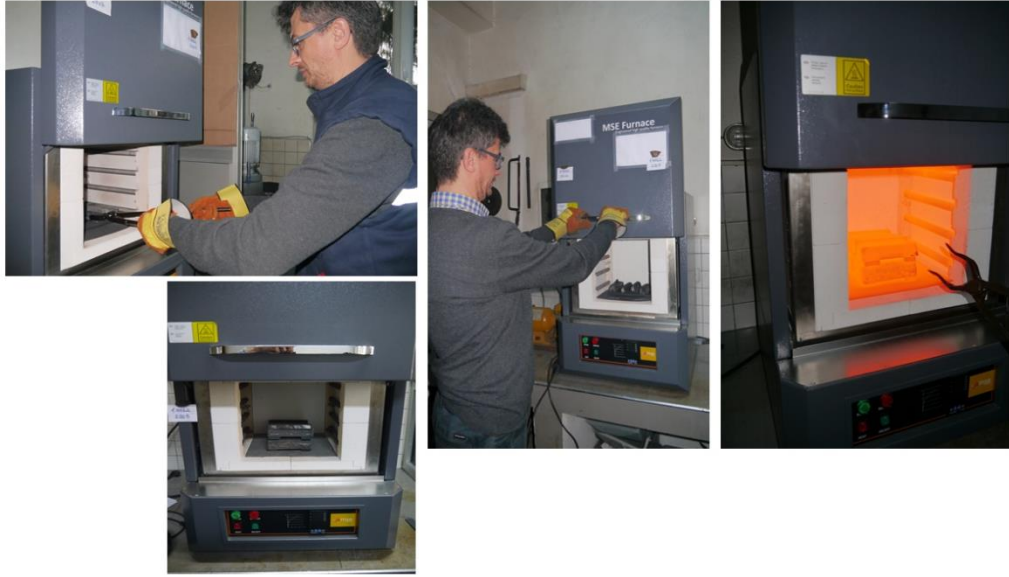
Şekil 3.18. MSE Furnace MS-1100 marka ısıl işlem fırını.
