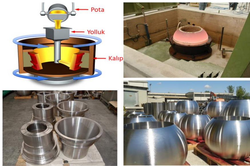
Şekil 2.13. Dikey savurma döküm görselleri verilmiştir [11] [12] [13].
