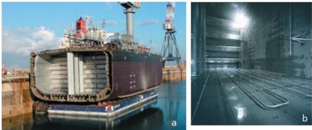
Şekil 2.2. (a) Kargo bölümü 2205 dubleks paslanmaz çelik kullanılarak imal edilmiş bir kimyasal tankerin kargo bölümü. (b) Dubleks paslanmaz çelik kullanılarak imal edilmiş bir kimyasal tankerin kargo bölümü [4].
