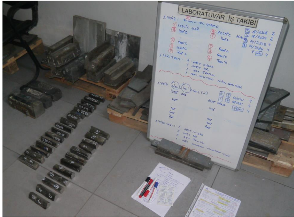
Şekil 3.2. Test bloklarından kesilen deney grupları test parçaları.
