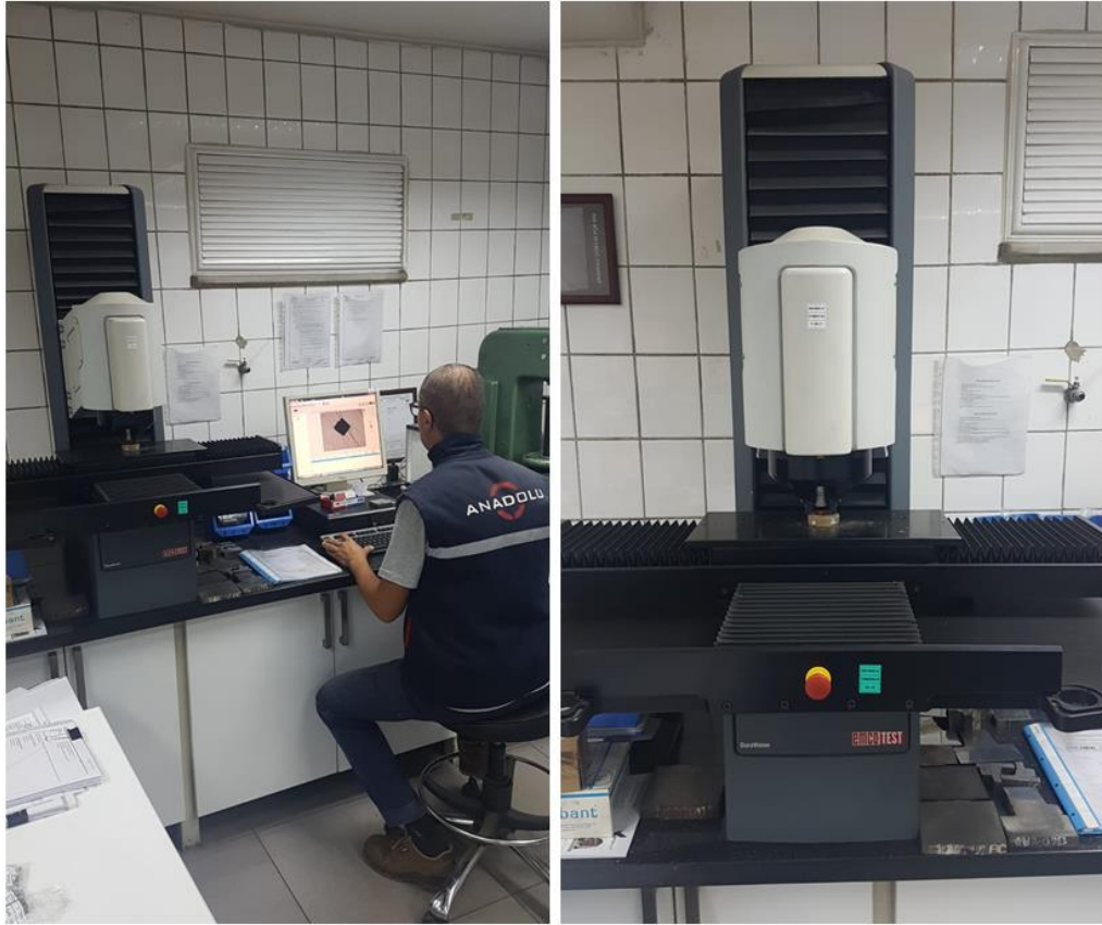
Şekil 3.11. Emco Duravision 250 sertlik test cihazı.
