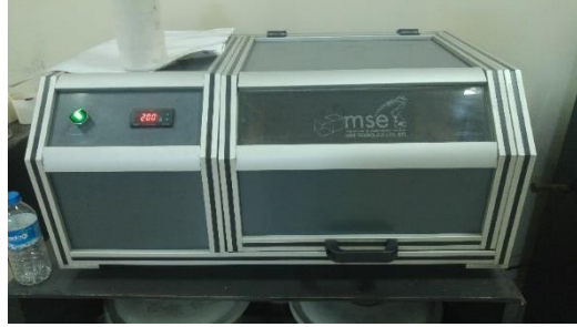
Şekil 4.2. MSE marka bilyalı değirmen
