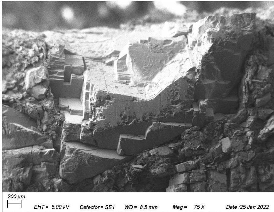
Şekil 5.54. 9 Numaralı Numune Pota Taban Bölgesi SEM Görüntüsü- SE
