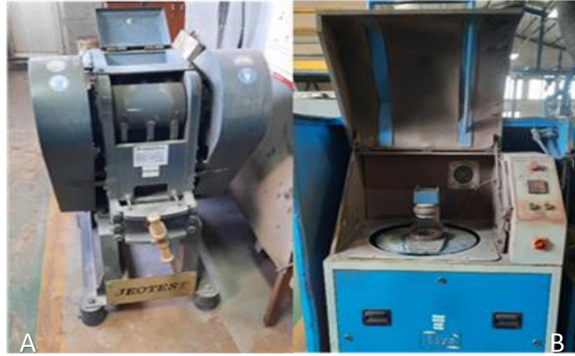
Şekil 4.5. A) Kırma B) Öğütme İşlemlerinin Gerçekleştirildiği Laboratuvar Ekipmanları
