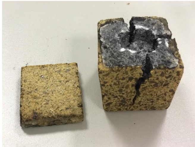
Şekil 5.3. Isıl işlem sonrası kırılma görülen numune
