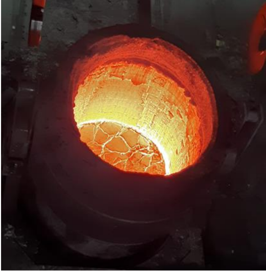
Şekil 3.13. Pota İçerisinde Cüruf - Çelik Bölgeleri [8].
