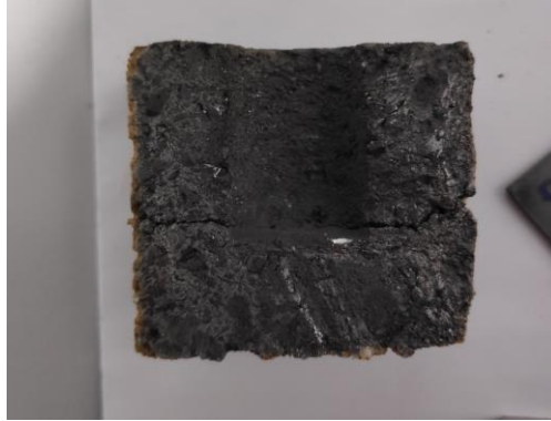
Şekil 5.1. Fırınlanmış ve kesimi tamamlanmış kroze örneği
