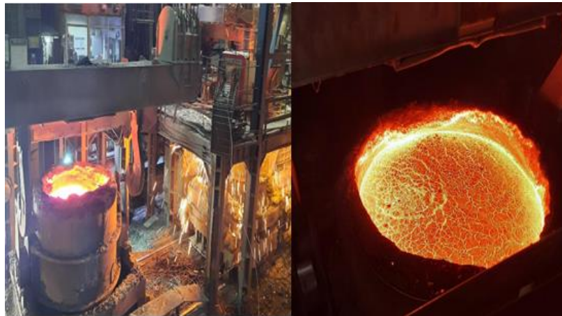
Şekil 3.4. Pota Fırını Alaşımlama - Dinlendirme Aşamaları [8].
