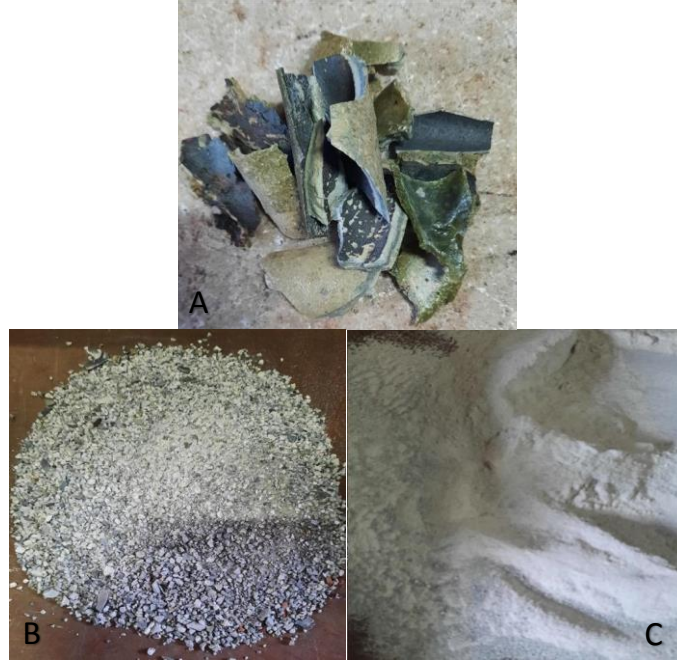
Şekil 4.6. A) Kırma, B) Öğütme, C) Eleme İşlemi Uygulanan Cüruf Numunesi
