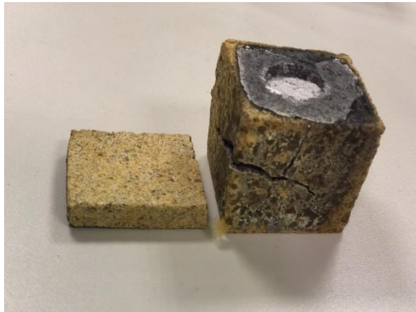
Şekil 5.4. Isıl işlem sonrası çatlama görülen numune
