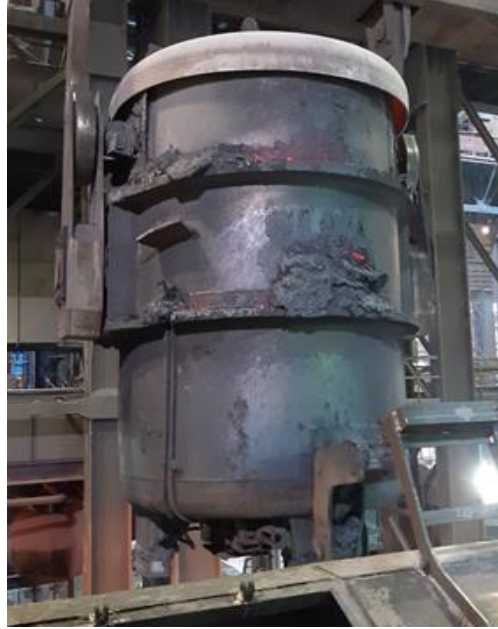
Şekil 3.5. Çelik Üretim Potası Transferi [8].
