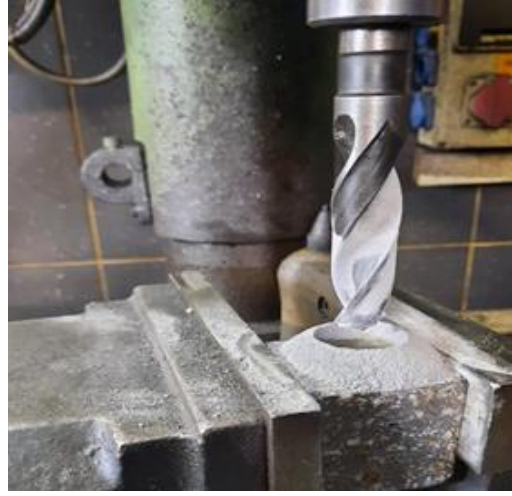
řekil 4.3. Krozenin Delinerek Oluřturulması
