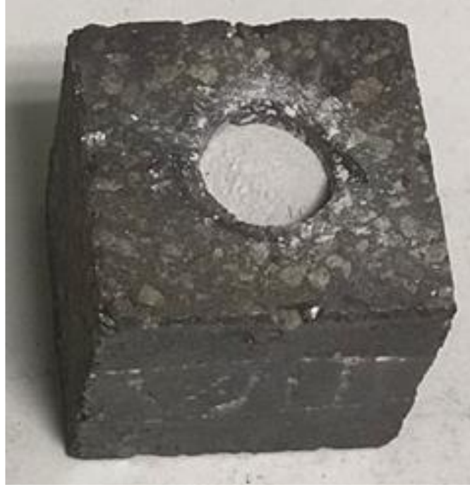
Şekil 4.7. 5x5x5 cm ebatlarında cüruf konulan kroze görüntüsü
