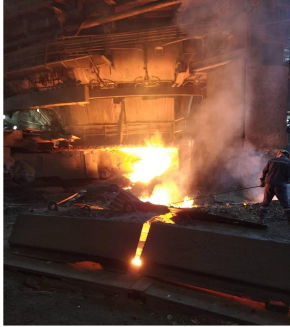
Şekil 3.4. Yüksek fırında döküm alma işlemi
