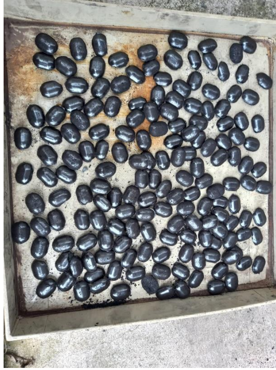
Şekil 6.15. Roll pres makinesinde üretilen briketler
