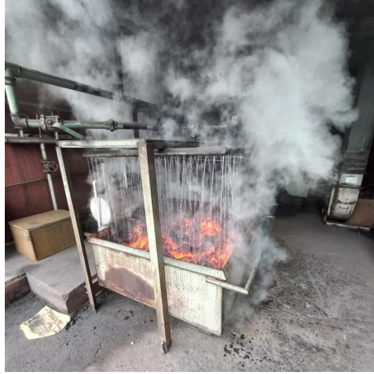
Şekil 6.21. Kok sulu söndürme işlemi
