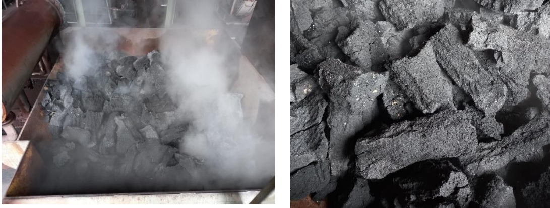
Şekil 6.22. Sulu söndürme işlemi sonrası elde edilen kok
