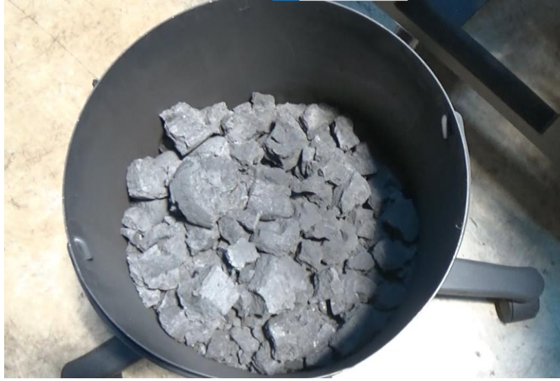
Şekil 6.6. Laboratuvar ölçekte üretilen reaktif kok
