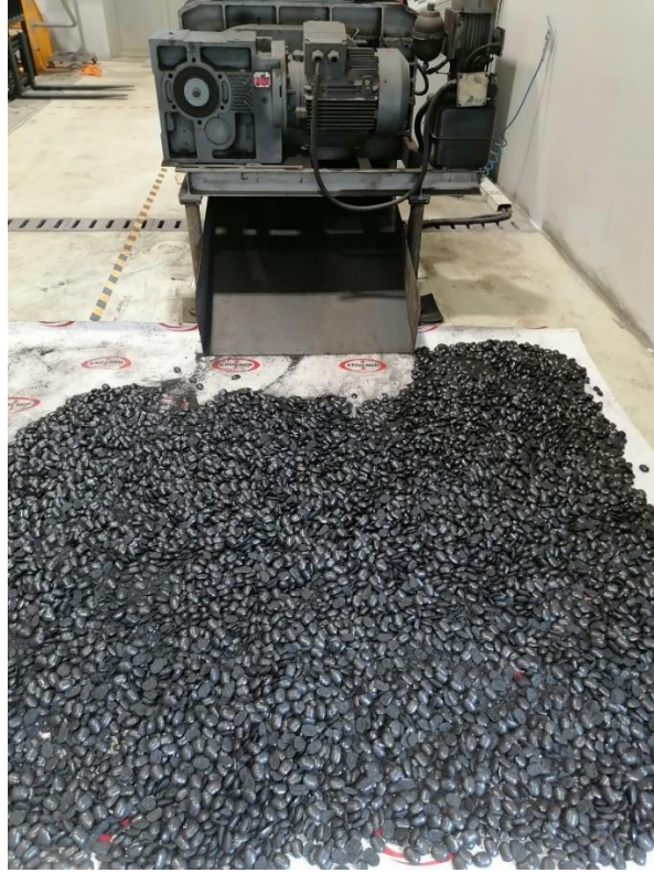
Şekil 6.23. Yarı endüstriyel deneme için üretilen briketler
