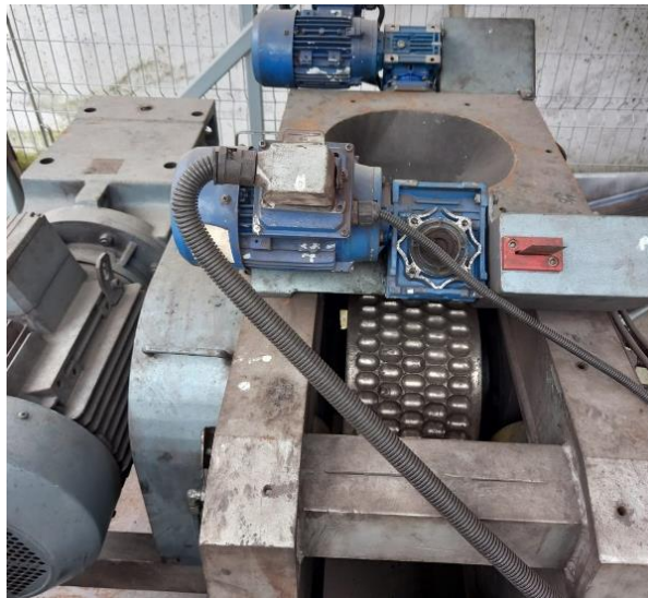
Şekil 6.14. Roll pres tipi briketleme makinesi
