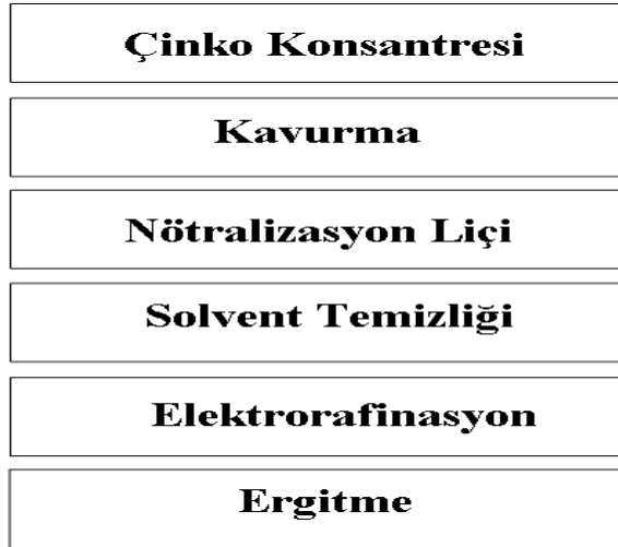
Şekil 2.15. Hidrometalürjik çinko üretim akış şeması
