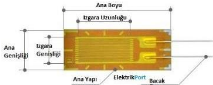
Şekil 2.8. Yaprak tipi gerinim ölçer gösterilmektedir.
