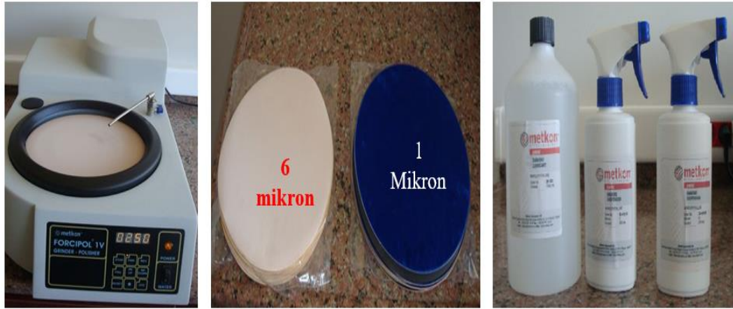
Şekil 4.18. Parlatma Cihazı, Parlatma Çuhaları Ve Parlatma Elmas Süsp. + (1 Ve6 M) + Elmas Suyu Gösterimi
