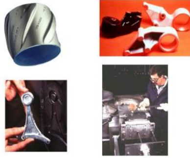
Şekil 1.2. Kokil kalıp ile üretilen parçalar (Gıyasettin E, 1979)
