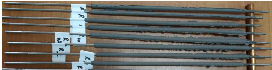
Şekil 4.3. Üretilen örtülü elektrotlar
