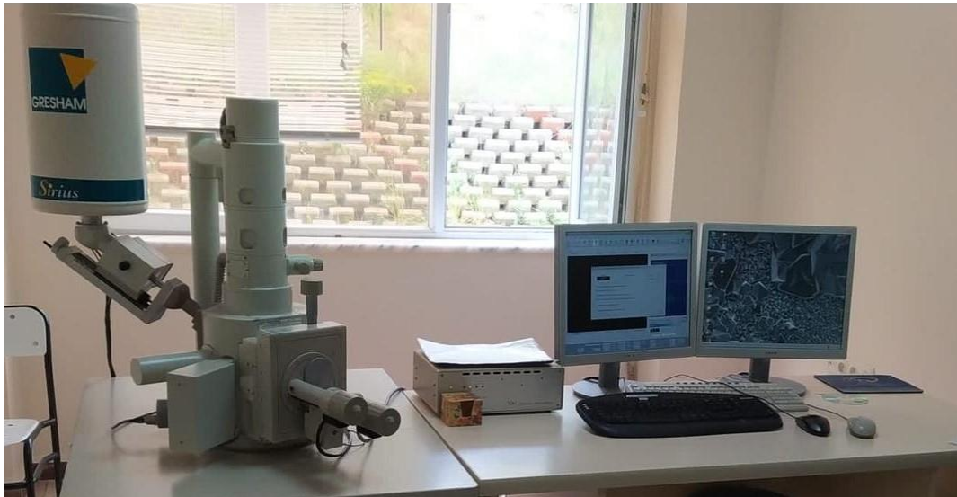
Şekil 4.6. JEOL JSM-6060 LV taramalı elektron mikroskobu (SEM)
