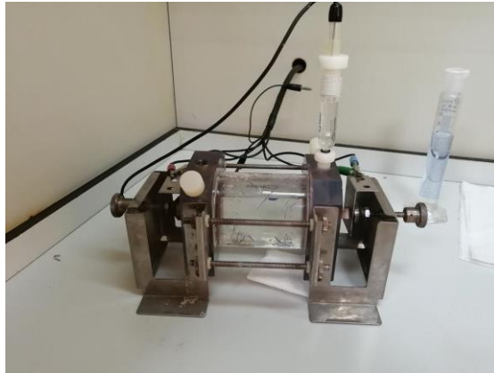
Şekil 4.11. Elektrokimyasal test ünitesine bağlı üç elektrot yöntemi ile çalışan yatay hücre
