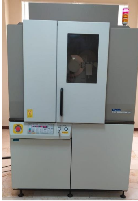
Şekil 4.7. RIGAKU D/MAX/2200/PC marka X-ışınları difraktometresi
