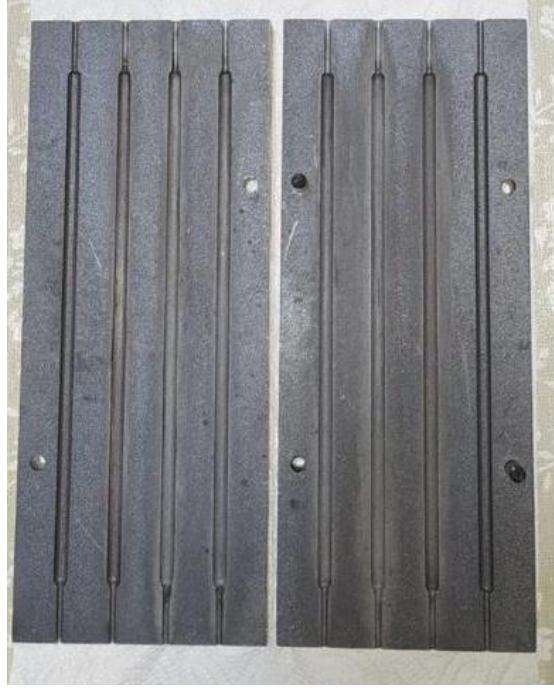
Şekil 4.1. Örtülü elektrot üretimi için kullanılan alt ve üst kalıp
