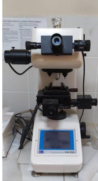
Şekil 4.8. Mikro sertlik testleri gerçekleştirilen FutureTech FM700 marka mikro sertlik cihazı
