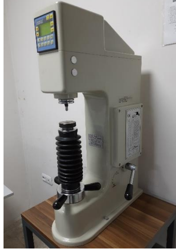
Şekil 4.9. Makro sertlik tesleri gerçekleştirilen Bulut Makine BMS-DIGIROCK-RB sertlik cihazı
