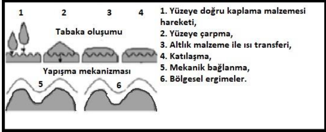
Şekil 2.7. Termal sprey tabakası oluşumu (Bunshah, 2001).
