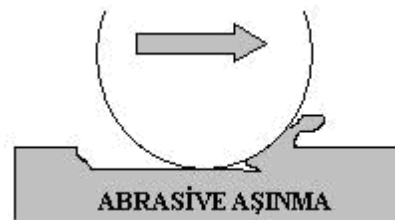
Şekil 3.2. Abrazif aşınma şematik gösterimi (Yıldız, 2006).
