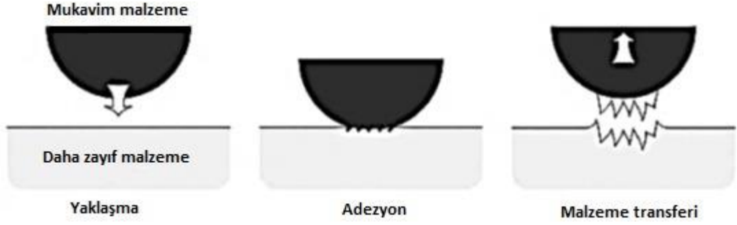
Şekil 3.5. Adhesif aşınma mekanizmasının şematik gösterimi (Biçer, 2015).
