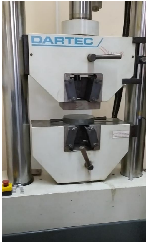
Şekil 4.3. 600kN kapasiteli servohidrolik kontrollü Dartec çekme makinası
