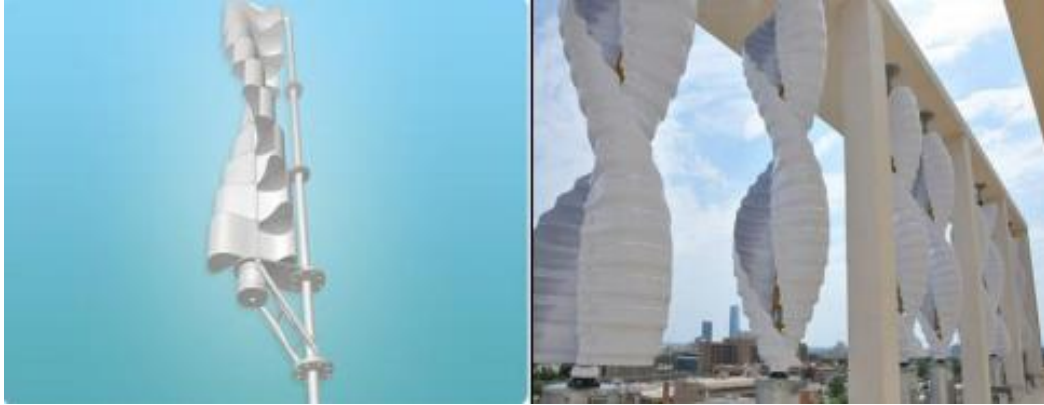
Şekil 3.9. Savonius tipi rüzgâr türbinleri [9]
