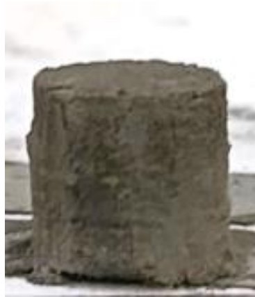
Şekil 3. 9. Binder Jetting yöntemi ile üretilen Ti test numunesi.
