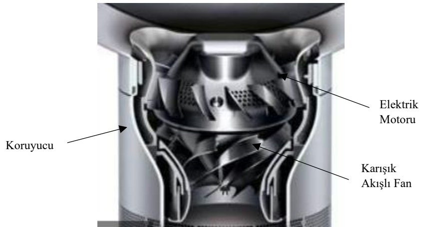
Şekil 1.3. Dyson hava çođaltıcı fan [6]
