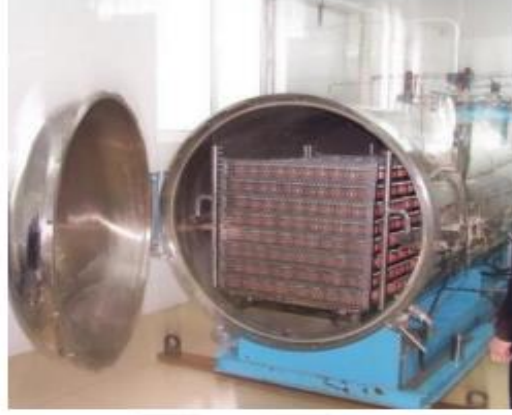
Şekil 2.28. Otoklavda vulkanizasyon (Kervan, 2010).
