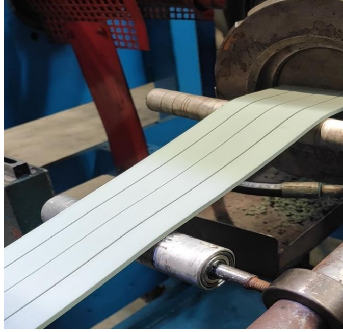
Şekil 3.9. Kauçuk karışımların ekstrüzyon hattında vulkanizasyonu
