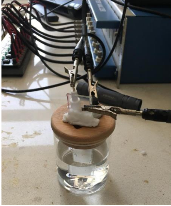
Şekil 3.1. Potansiyostat ölçümü için hazırlanmış \text{Na}_2\text{SO}_4 çözeltisi içerisinde daldırılmış CaO kaplı ITO'nun konulduğu hücre.
