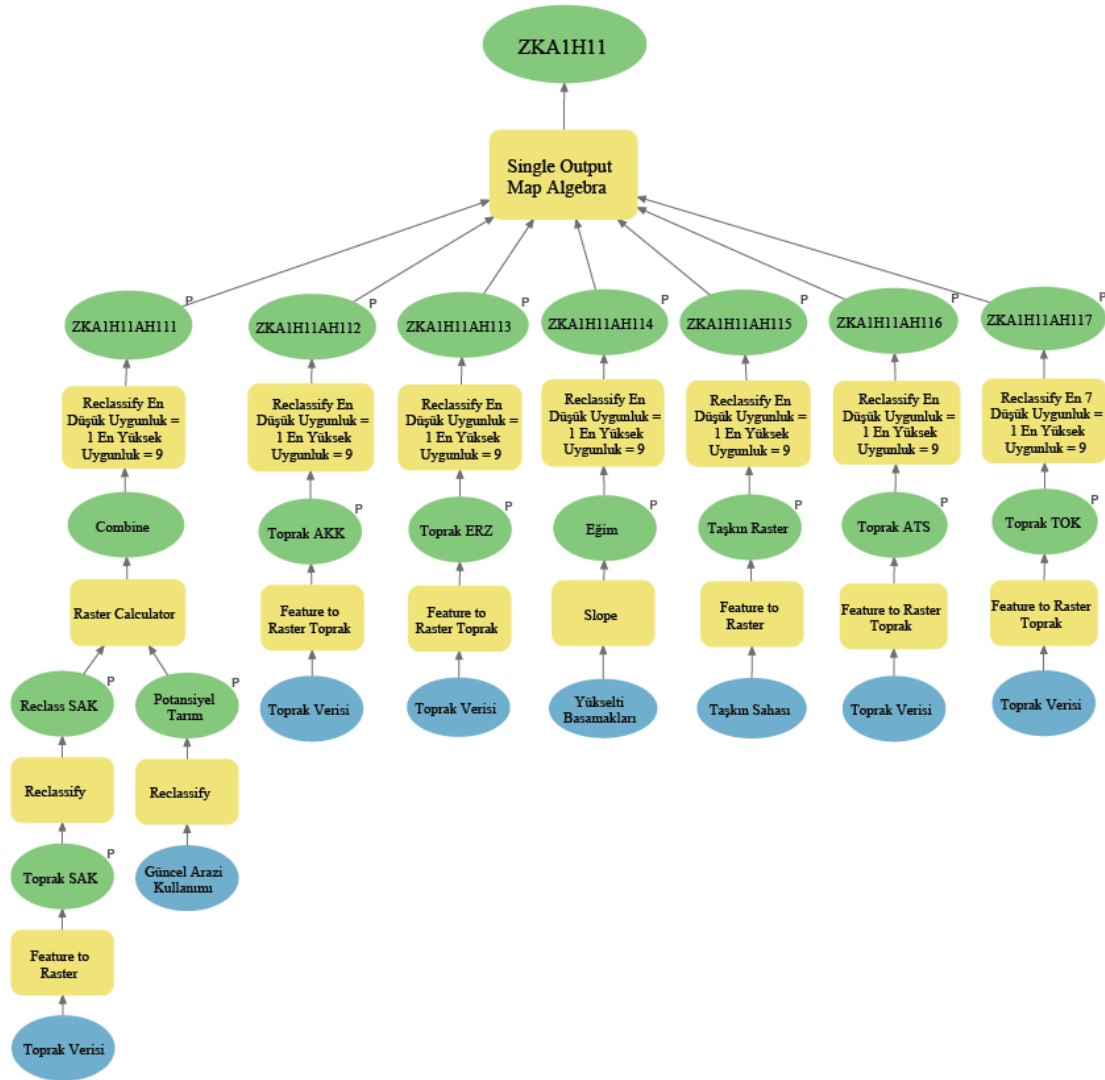
Model 1: Fiziksel Açından Tarla Tarımına Uygun Toprakların Belirlenmesi Amacıyla Oluşturulan Model (ZKA1H11)
