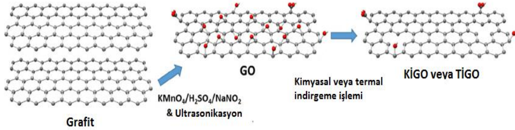
Şekil 3.2. Grafitten GO üretimi ve indirgenmiş grafen oksite geçişin şematik görüntüsü [101].
