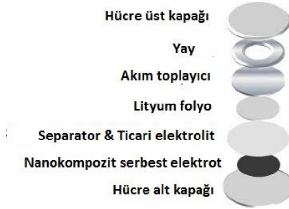
Şekil 3.3. CR2016 test hücresinin parçaları.
