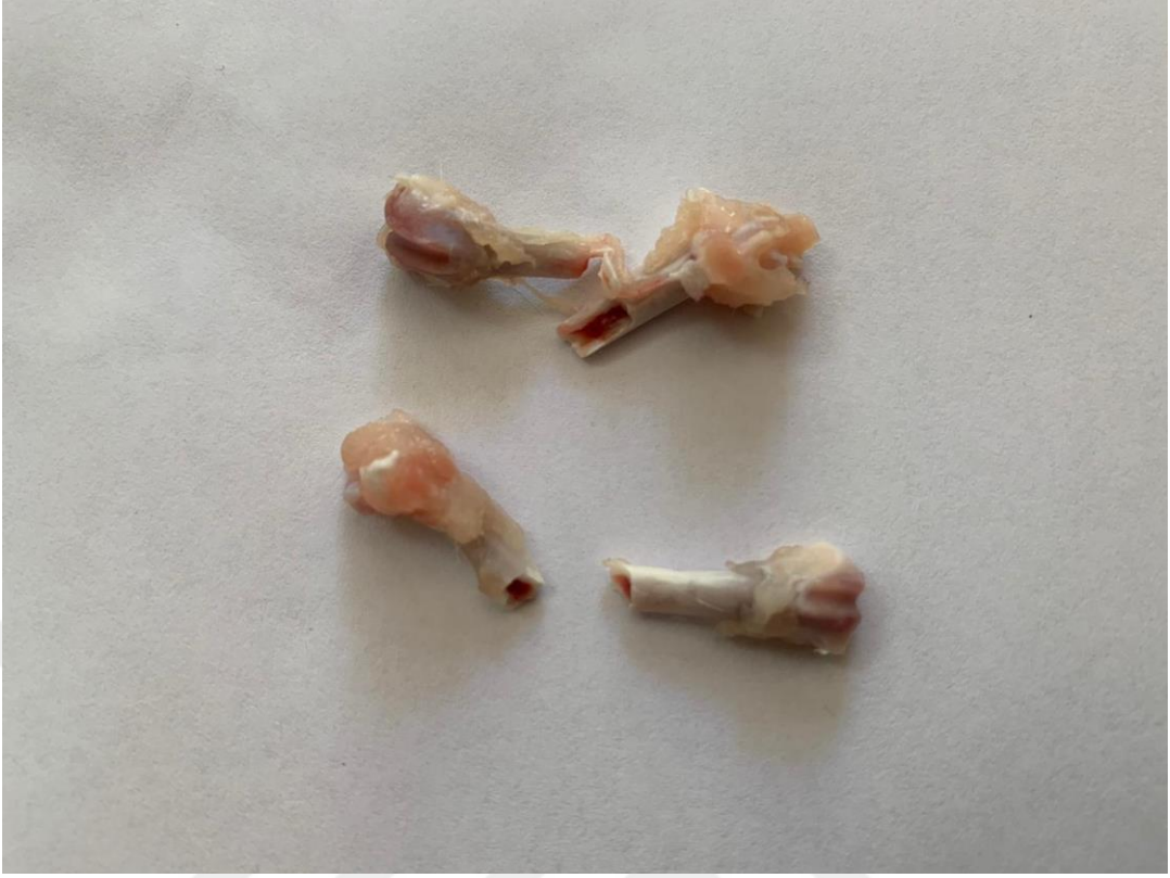
Resim 24: 3 nokta yüklenme testi sonrası kırık gelişen femur kemik örneği
