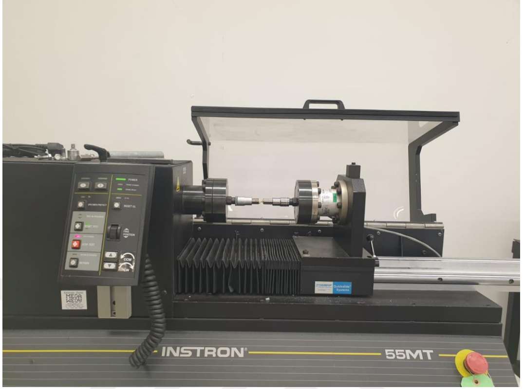
Resim 15: Torsiyon yüklenme için kullanılan Instron 55MT test makinesi
