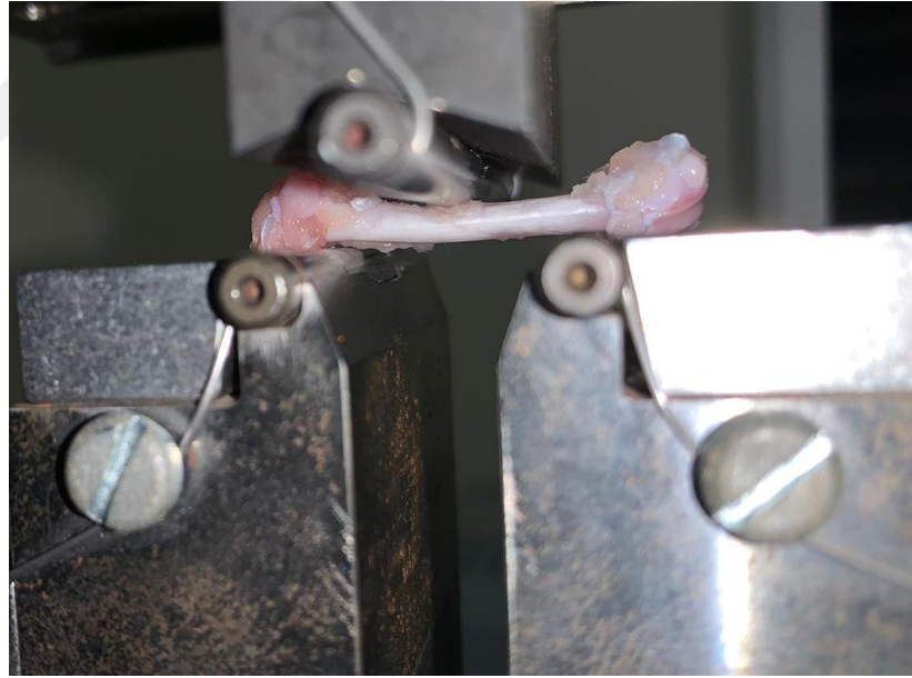
Resim 23: Femur kemiği diafizinde nondeplase kırık hattı oluştuğu gözlenmekte
