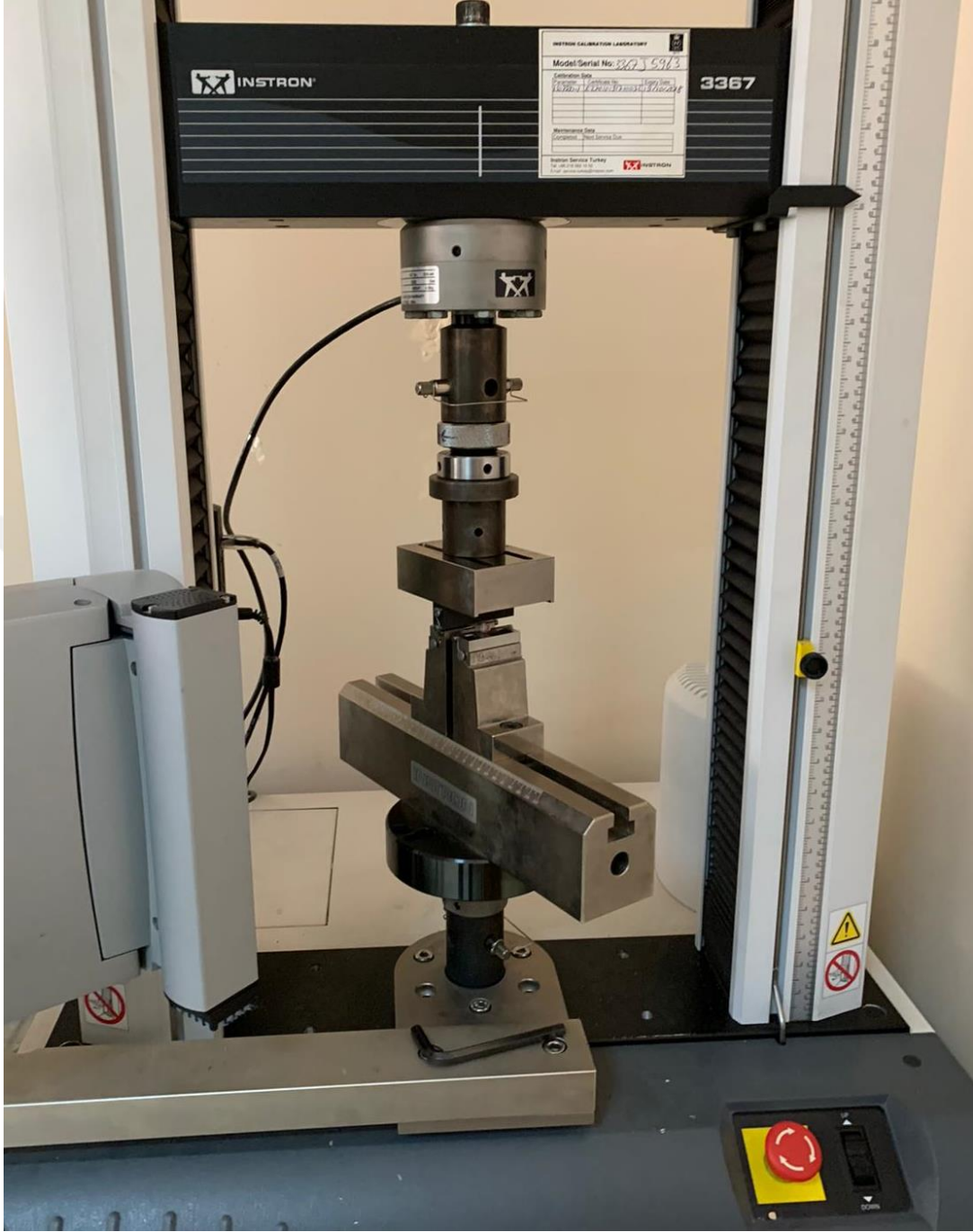
Resim 21: 3 nokta stres testinde kullanılan Instron 3367J5963 makinesi
