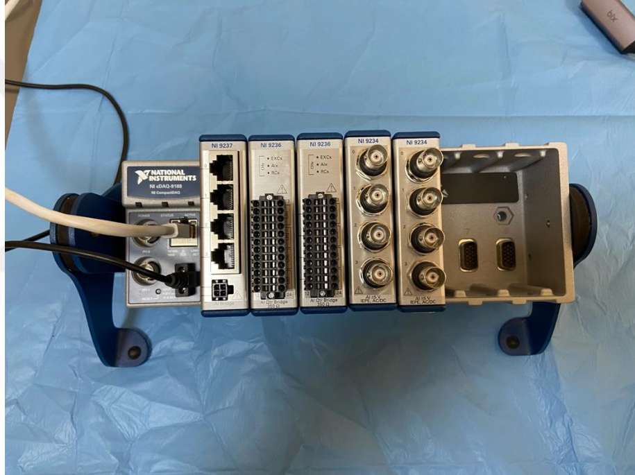
Resim 12. Oluřturulan modelde dik iřleme merkezinin ve gerilim ölçerlerin verilerinin toplanması için kullanılan modül
