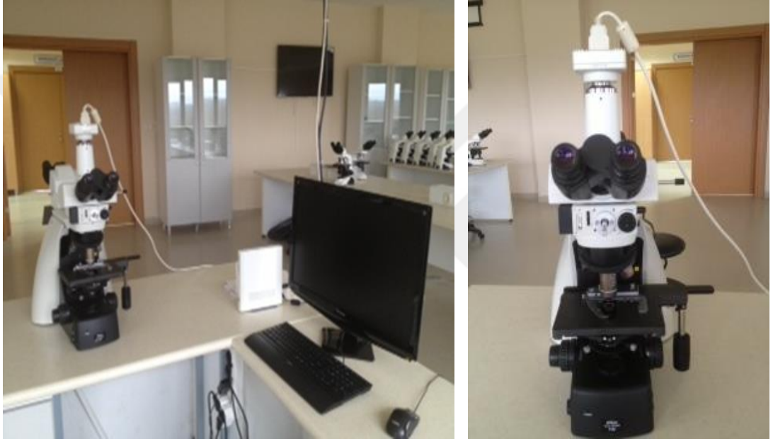
Resim 9: Renkli dijital kamera ataçmanlı ışık mikroskobu ve görüntüleme sistemi
