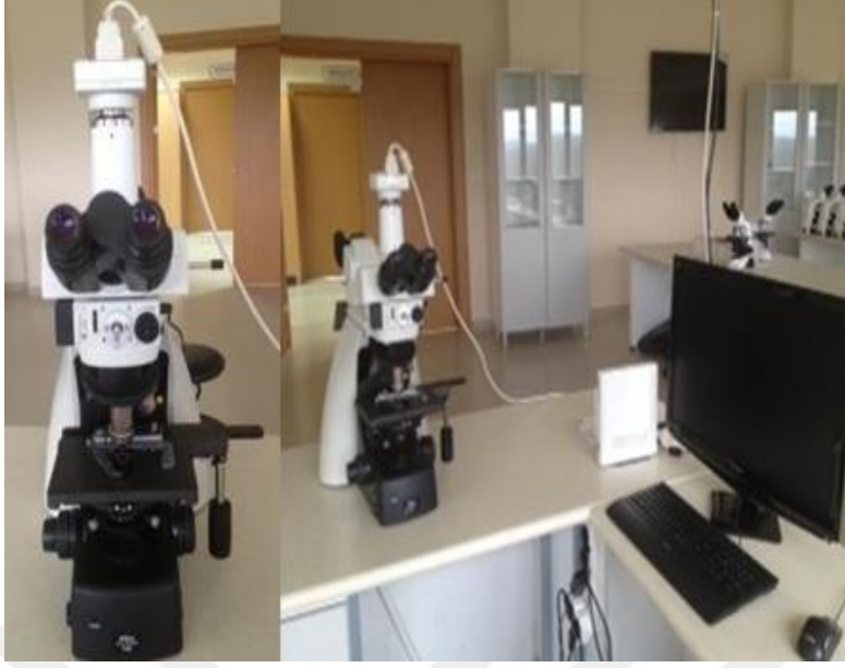
Resim 15: dijital kamera ataçmanı bulunan ışık mikroskobu ve görüntüleme sistemi
