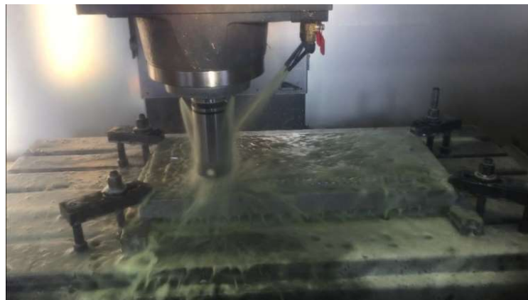
Şekil 5.16. Tip-1 plakasının 3D işlenmesi resmi
