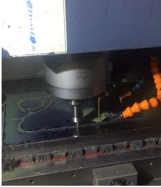
Şekil 5.20. Tip-1 plaka conta kalıbı işlenmesi
