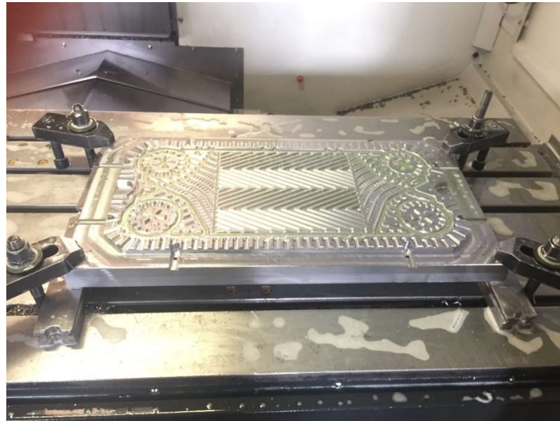
Şekil 5.18. Tip-1 plakasının yüzey işlemeden sonraki resmi
