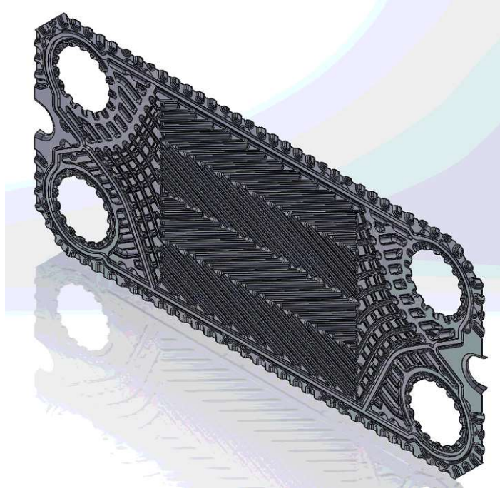
Şekil 3.2. Tip-1 standart plaka parametrik modeli
