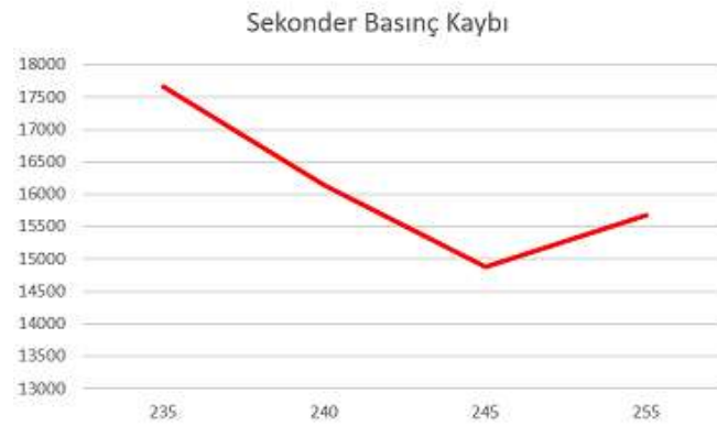
Şekil 4.31. Tip-3 plaka tasarımı sekonder basınç değişimi
