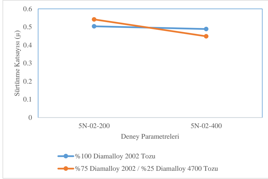
Şekil 6.13. 5N yük altında, 200 ve 400 m mesafede 0,2 m/sn hızda aşınma sonucu numunelere ait sürtünme katsayısı-yol grafiği
