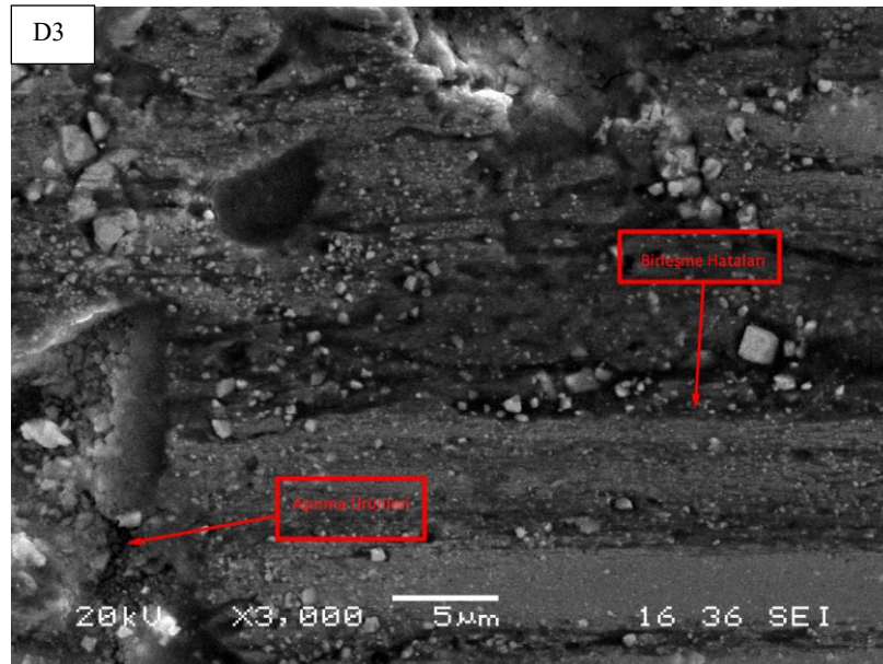
Şekil 6.25. %75 Diamalloy 2002 ve %25 Diamalloy 4700 toz karışımı (D numunesi) kullanılarak 3N yük altında 0,4 m/sn hızla 200 metre mesafede aşınan numunenin SEM görüntüleri
