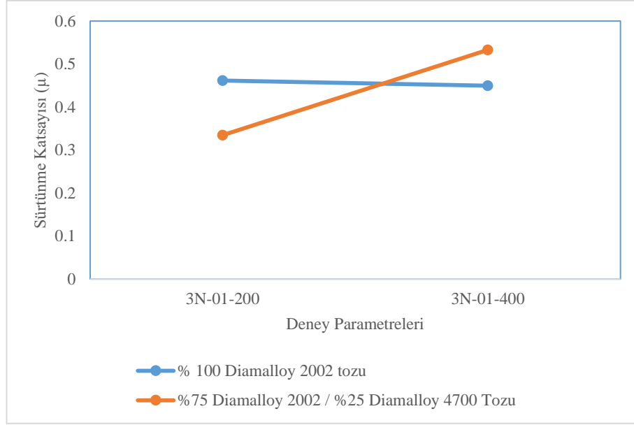
Şekil 6.10. 3N yük altında, 200 ve 400 m mesafede 0,1 m/sn hızda aşınma sonucu numunelere ait sürtünme katsayısı-yol grafiği
