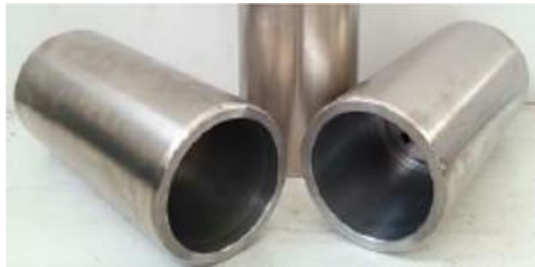
Şekil 2.5. Alev Toz Püskürtme yönteminin uygulama örneği [13].
