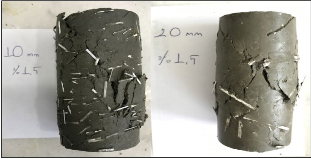
Şekil 5.4. Silindirik numunelerin serbest basma sonrası oluşan kırılma yüzeyleri.
