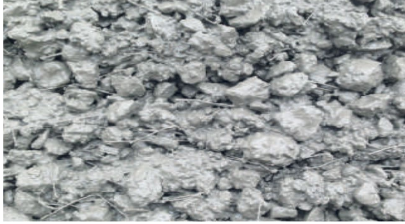
Şekil 4.4. KraTos Makronun beton içinde homojen dağılımı (URL-5).
