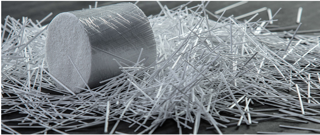
Şekil 4.3. Polipropilen fiberin görünümü (URL-5).
