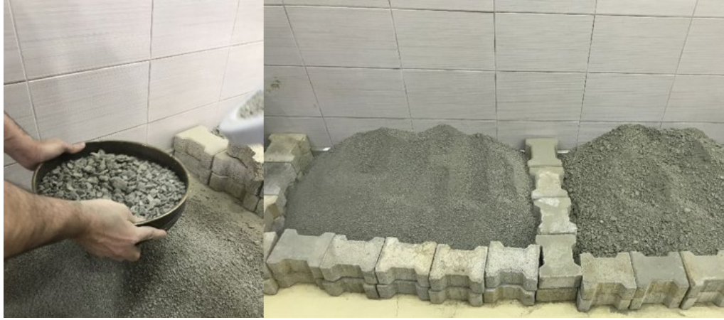
Şekil 4.1. 4 nolu elekten elenen kil zemin.
