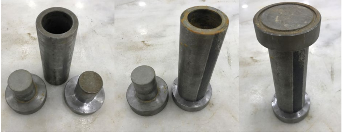
Şekil 4.17. 3,50 cm çap, 7,00 cm yüksekliğe sahip sıkıştırma kalıbı.
