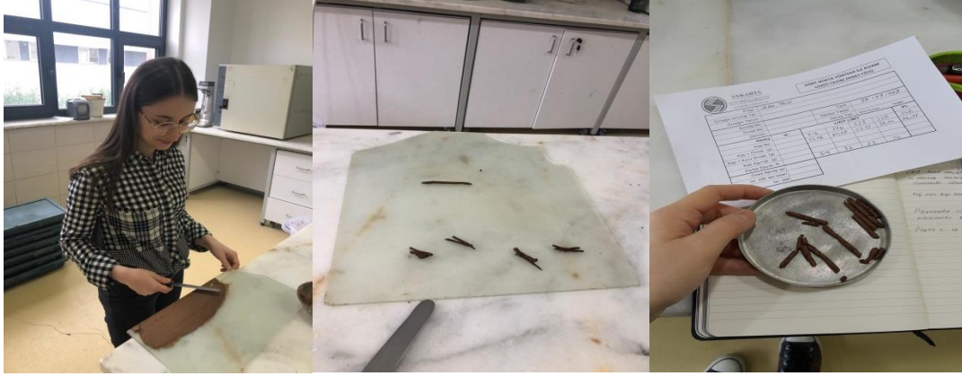
Şekil 4.5. Plastik limit deneyi yapılışı.
