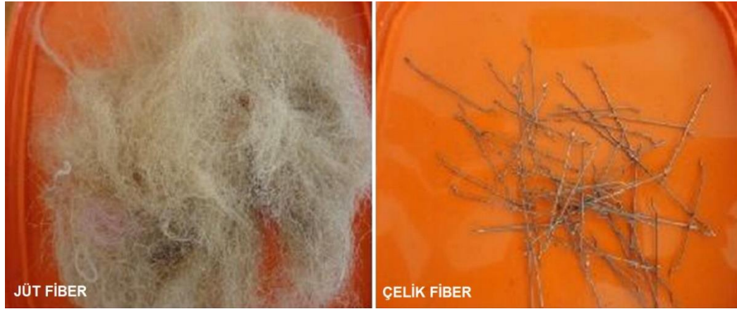
Şekil 2.2. Jüt ve çelik fiber örnekleri (Güllü ve Khudir, 2014).
