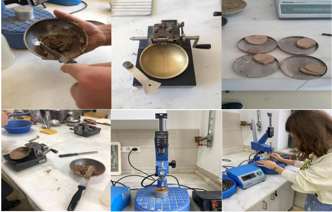
Şekil 4.4. Casagrande ve Konik Penetrometre deneyi yapılışı.
