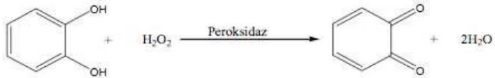
Şekil 2.15. POD fenolik substratı kullanarak hidrojen peroksit giderme mekanizması [76]
