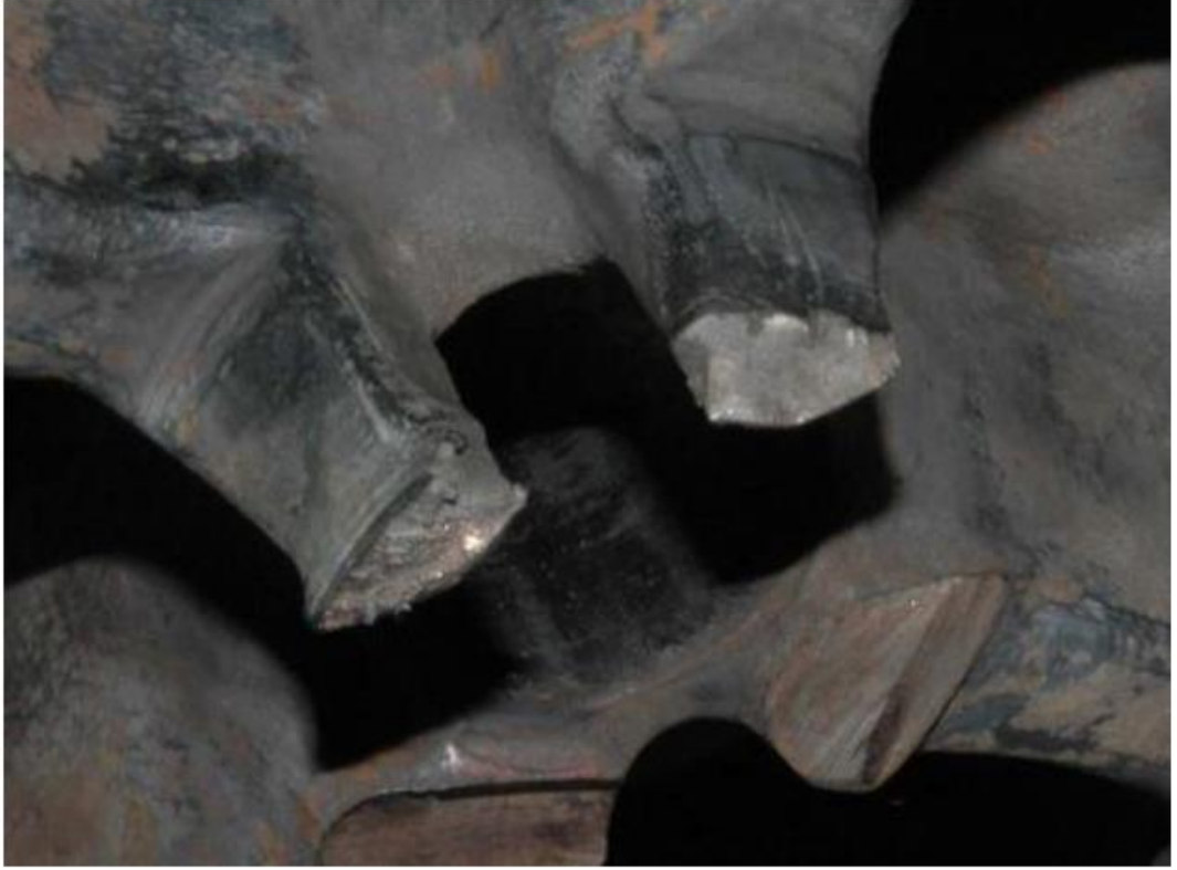
Şekil 4.11. Kırık yüzey örneği - üst kısımda gevrek, alt kısımda sünek kırılmaya örnek [37].
