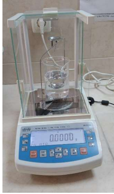
Şekil 4.3. Yoğunluk ölçümü için kullanılan dijital terazi
