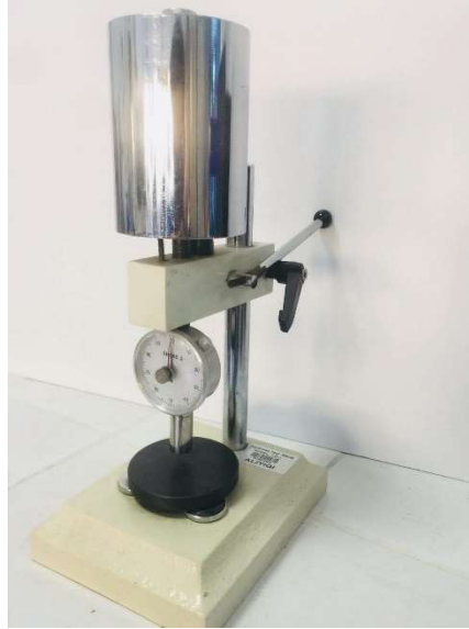
Şekil 4.8. Shore D sertlik ölçüm cihazı
