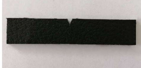
Şekil 4.5. Çentikli Izod darbe deney numunesi
