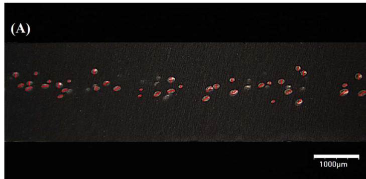
Şekil 5.2. (A) %1 KKK, (B) %1,5 KKK ve (C) %2 KKK'lı PP köpük numunelerin köpük hücre dağılımı
