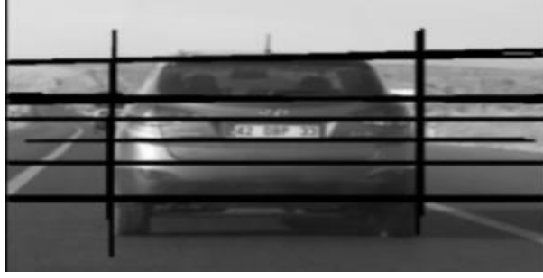
Şekil 3.28. Harris ve Stephens algoritması ile yatay ve düşey doğrultuda köşe tespiti [2].
