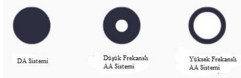
Şekil 3.7. Frekansa göre akımın kabloda ilerleyişi
