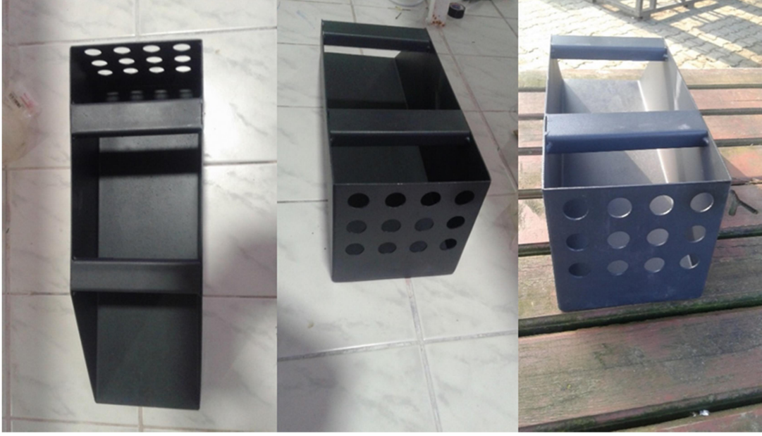
Şekil 5.2. Yağmur suyu kanallarında birikim yapan kum vb. maddelerin toplanması için geliştirilen kum tutucu prototipi.
