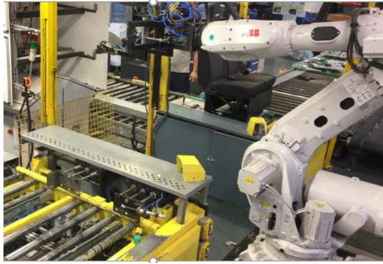
Şekil 4.4. Hat sonuna kurulan koltuk kaldırma robotu
