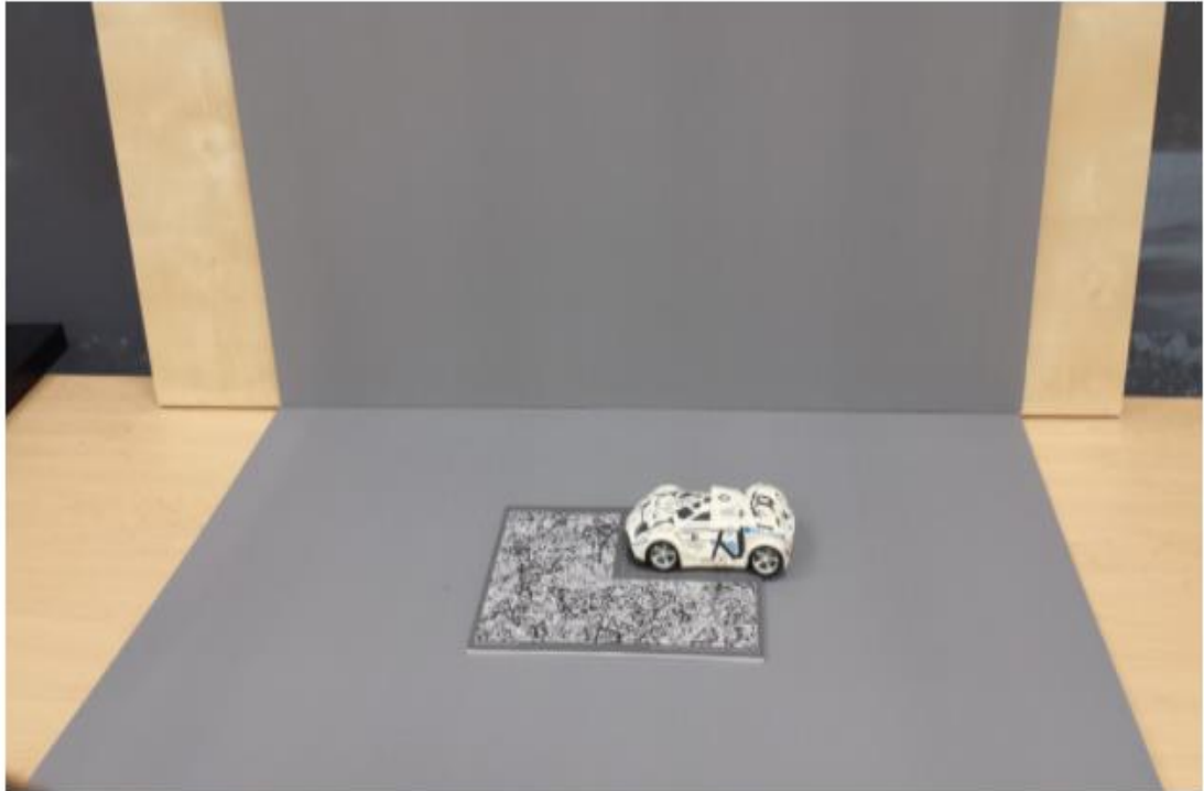
Şekil 3.8. Gri karton kullanarak yapılan tarama aşaması [28]
