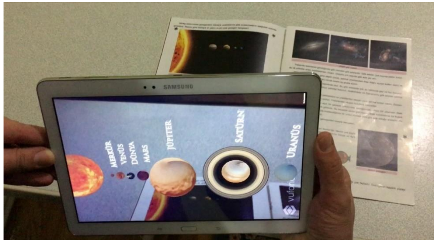
Şekil 3.2. İşaret tabanlı artırılmış gerçeklik sistemi örneği
