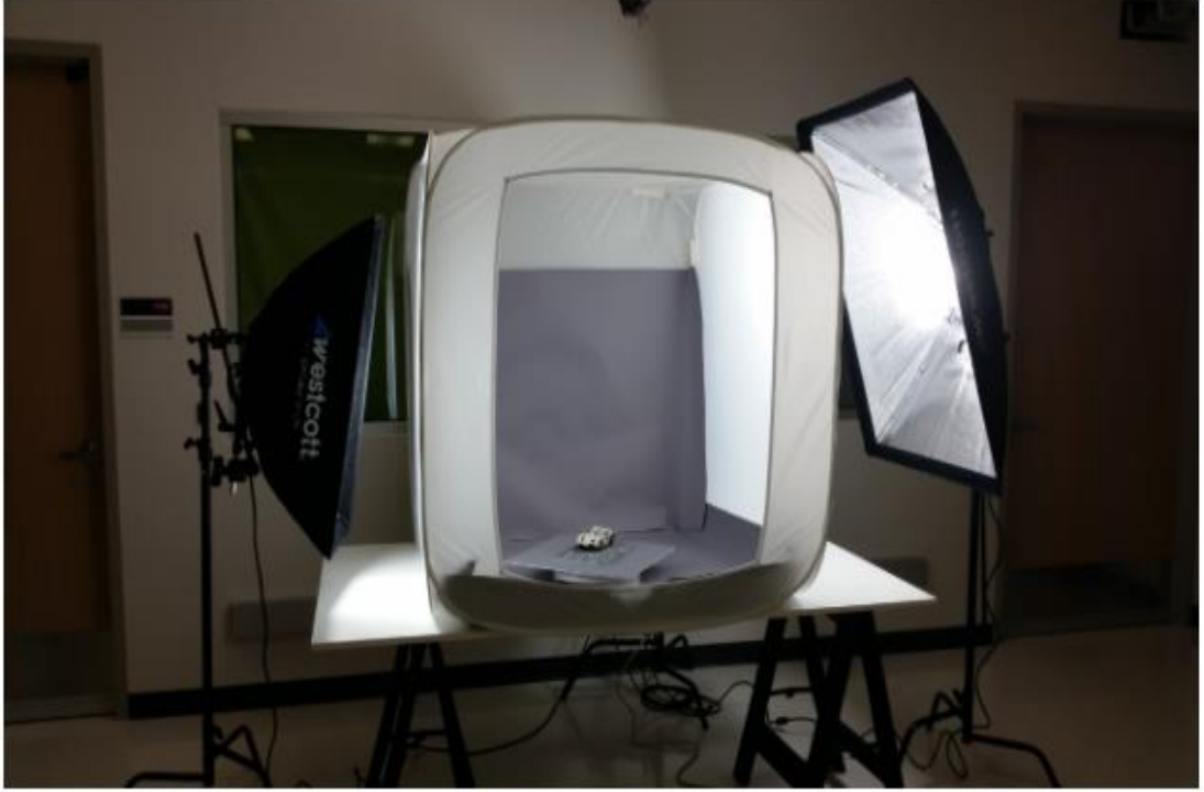
Şekil 3.9. Hafif bir çadır ve döner tabla kullanan bir sahne ile yapılan tarama aşaması [28]
