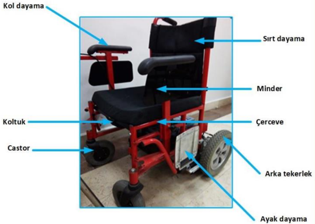
Şekil 3.1. ETS ve fiziksel donanımları [92]
