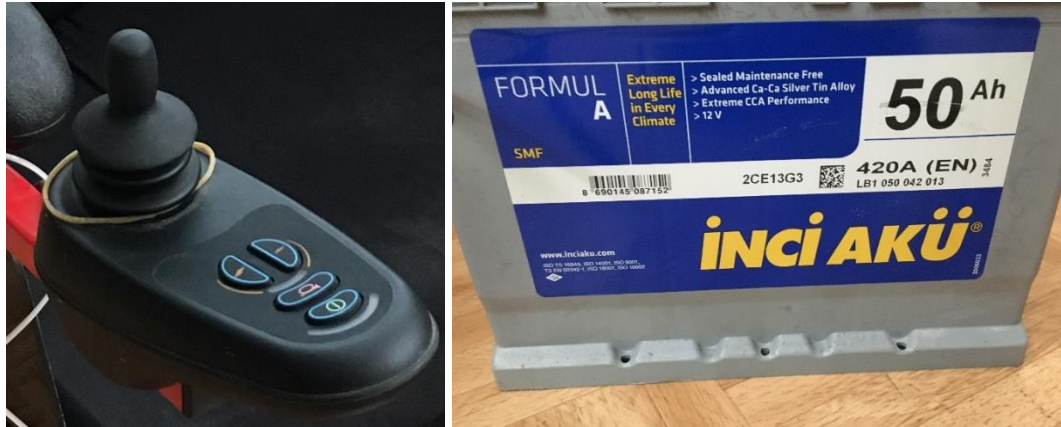
Şekil 3.3. ETS kumanda kolu donanımı (solda), ETS'de kullanılan kurşun asit pil türü (sağda)
