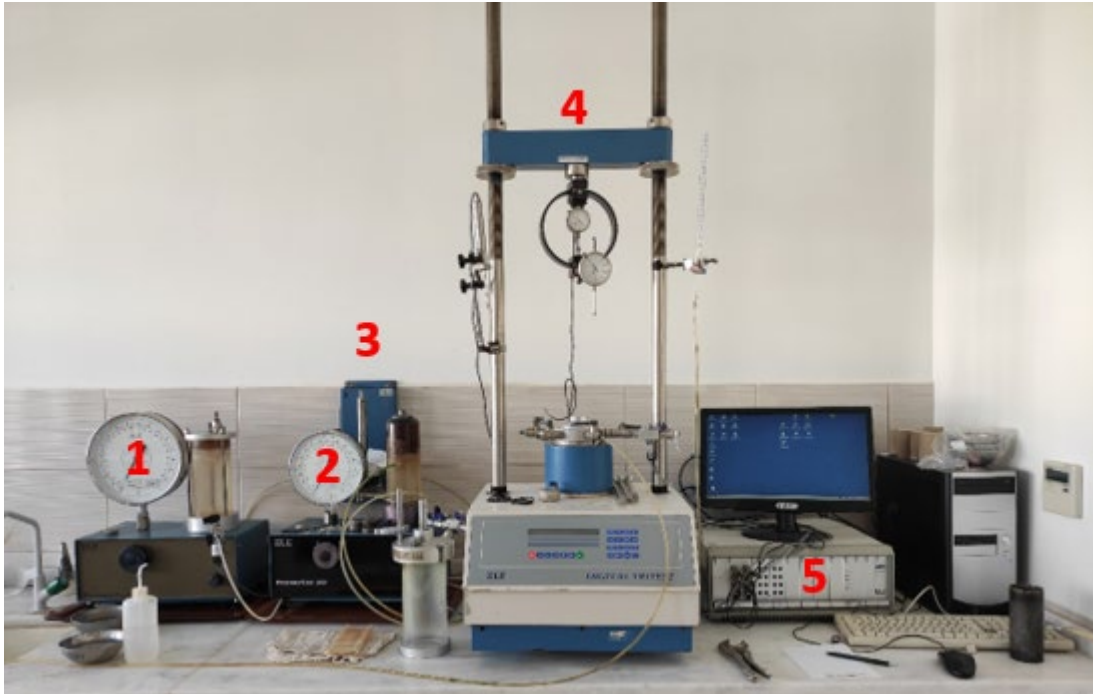
Şekil 3.3. Üç eksenli hücre kesme deney düzeneği
