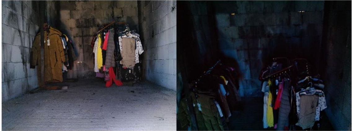
řekil 3.20. B2 Düz sıra ve dairesel dizilimi yangın atlaması deneyi ürün askı düzeni
