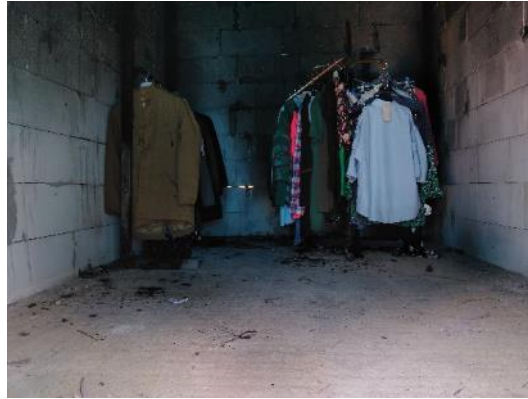
Şekil 3.19. B1 Düz sıra ve dairesel dizilimi yangın atlaması deneyi ürün askı düzeni
