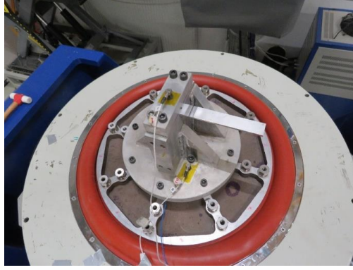
Şekil 3.27. Numunenin sarsıcı tabla testinin kurulumu [37]
