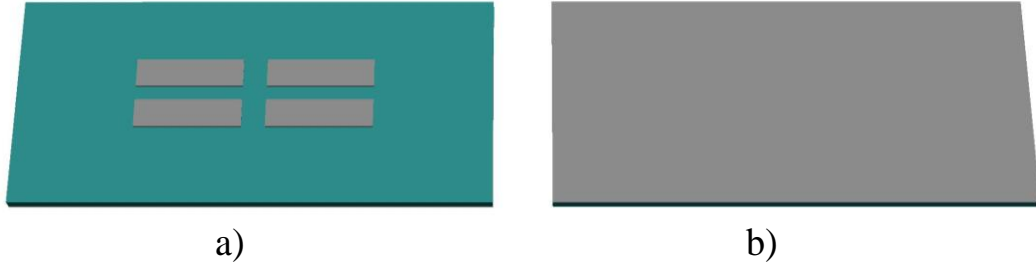
Şekil 2.14. 2x2 elemanlı mikroşerit dizi antenin a) Üstten görünüşü b)Alttan görünüşü
