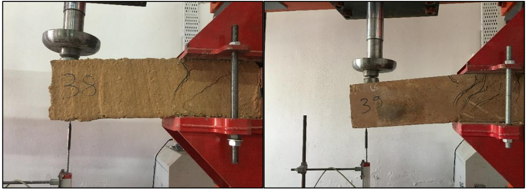
Şekil 5.6. Çatlak tespiti ile ilgili görseller
