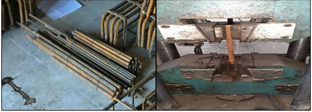
Şekil 5.2. Numunelik donatıların çekme deneyi işlemi
