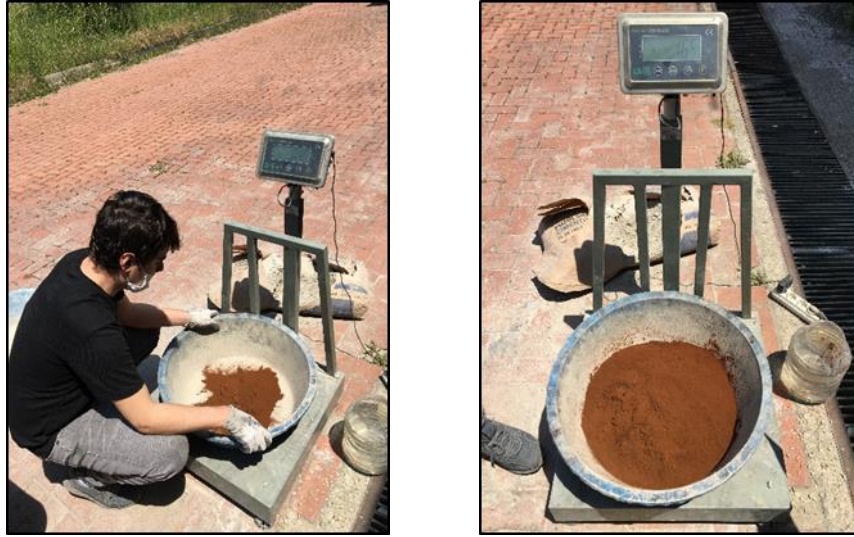
Şekil 4.14. Demir tozunun hazırlanması
