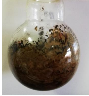
Şekil 5.19. 24 saat 105 °C’de vakum ortamında manyetik karıştırıcıda karıştırıldıktan sonra gözlenen kahve rengi sarı renkli ürün (R3)
