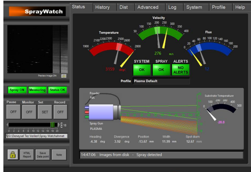
Şekil 6.9. Spray Watch sistemi kaplama esnasındaki partikül özellikleri.
