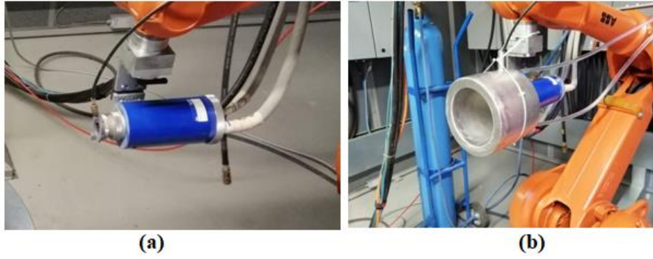
Şekil 5.10. (a) APS ve (b) Shroud IPS kaplama tabancaları [54].
