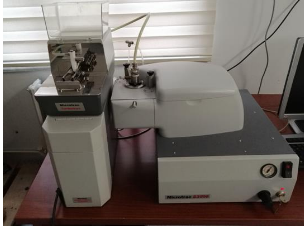
Şekil 6.1. Toz boyutu ölçüm cihazı.
