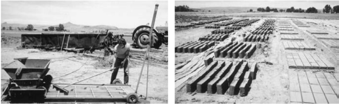
Şekil 2.11. Huni ile doldurulan ahşap kalıplar [18].
