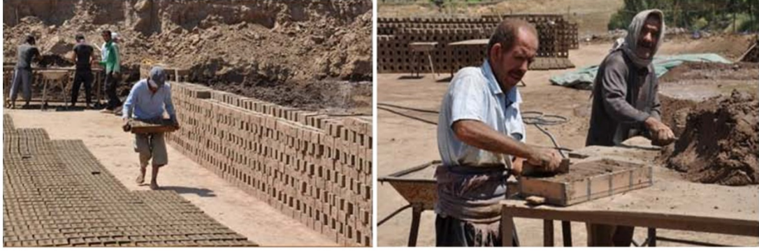
Şekil 2.1. Kalıbı doldurmak ve kurutmak için güneşin altında bırakma [15].
